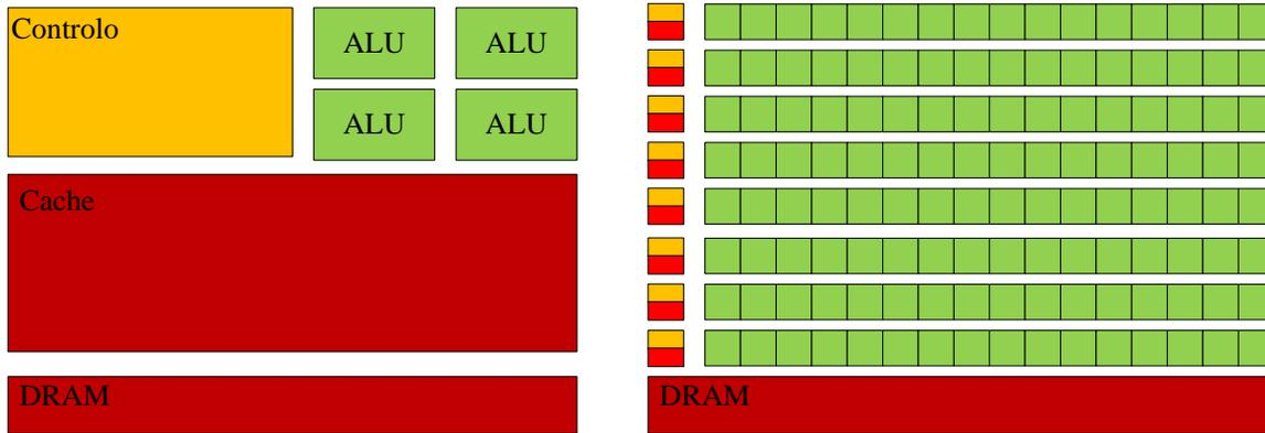
**Figura 2.2:** Comparação entre a aplicação dos transístores em GPUs e CPUs. As GPUs são especializadas para computação altamente paralela, pois mais transístores são dedicados ao processamento de dados, em vez de existirem transístores dedicados ao controlo de fluxo e à cache de dados como existem nas CPUs.
