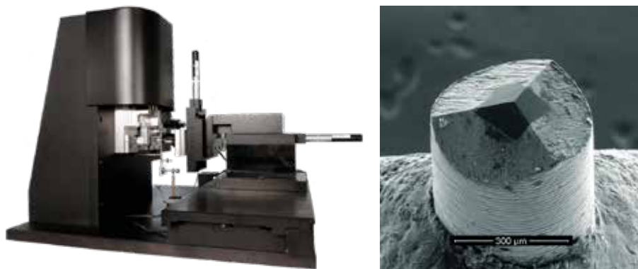
Figura 2.14 – Equipamento para nanoindentação da Micro Materials com um indentador de diamante Berkovich (geometria piramidal triangular).
