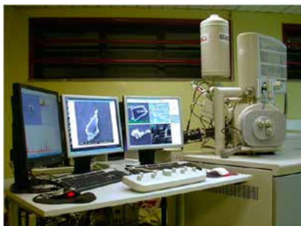
Figura 2.9 – Microscópio de emissão de campo de alta resolução FEI Quanta 400FEG ESEM.
