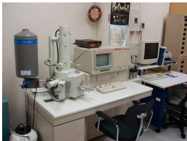
Figura 2.8 – Microscópio electrónico de varrimento (SEM) equipado com um espectrómetro de dispersão de energia (EDS – Energy Dispersive Spectroscopy).
