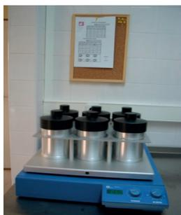
Figura 3.19 – Dispositivo de agitação para desidratação e infiltração do sistema Exakt®.
