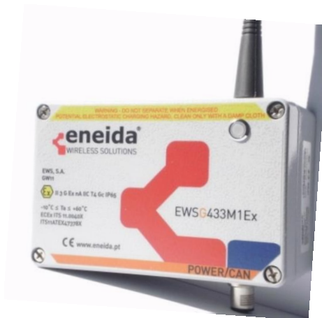
Figura 41: Gateway CAN-433MHz, certificada para ATEX zona 2.
