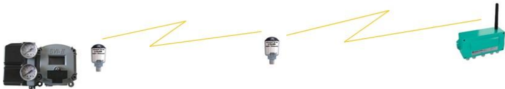
Figura 16: Esquema da rede wirelessHART.
