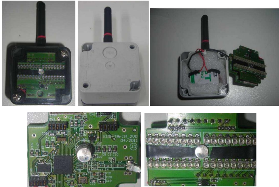
Figura 31: Protótipo em ensaios CE. Em cima: montagem final do protótipo. Em baixo, à esquerda: PCB anterior; à direita: PCB posterior.
