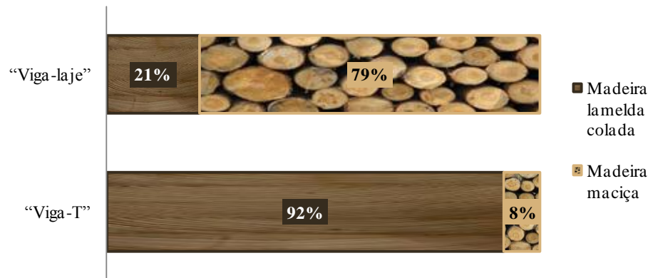
Figura 3.17 – Tipos de produtos de madeira utilizados nos tabuleiros das pontes da amostra estudada em função da sua tipologia.
