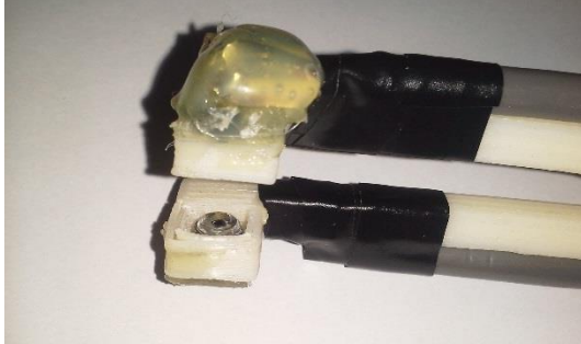
Figura 23: Local de ligação dos fotodíodos e LED's na pinça com especial atenção no fotodíodo
