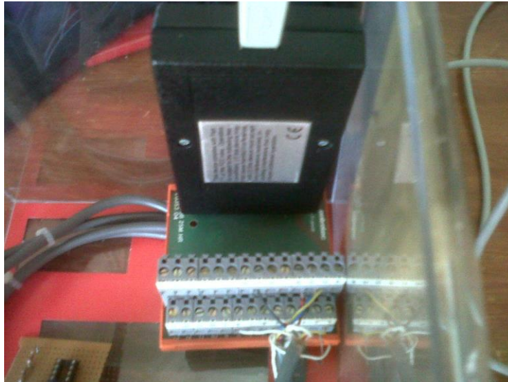
Figura 21: Módulo de aquisição de sinal exterior ao molde do sensor
