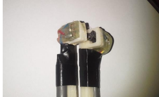
Figura 24: Local de ligação do fotodíodo e LED's na pinça, com especial atenção nos LED's
