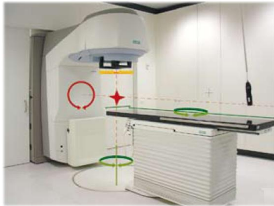
Figura 3.4 – Movimentos de rotação das componentes do acelerador linear: vermelho – gantry; amarelo – colimador; verde – mesa. Na interseção dos eixos de rotação do colimador e da gantry está o isocentro [6].
