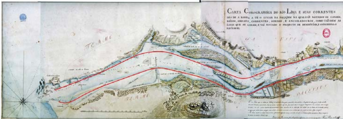
Fig. 74, Francisco Pinheiro da Cunha, Carta Corographica do Rio Lima e suas correntes desde a Barra até o lugar da Paçagem na qual vão notados os canaes, baixos, areas, correntes, sondas, e ancoradouros como taõ bem as Ilhas que se acham, e vai notado o projecto de beneficiar, e conservalo navigavel , 27 de Março de 1782, Arquivo SGL, Cartoteca, 6-D-12 (pormenor; — hipótese de traçado dos diques propostos por José Auffdiener, entre a foz do rio Lima e o Porto da Barca; sublinhado nosso).
