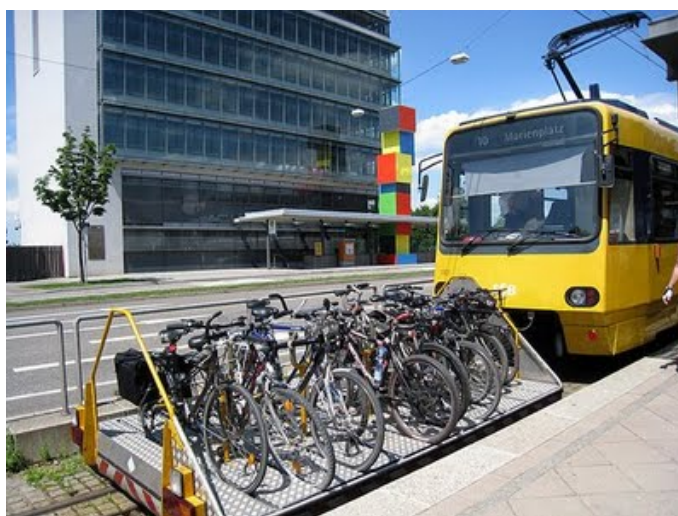
Fig. 6 – Plataforma de transporte de bicicletas para metro de superfície, em Estugarda.
