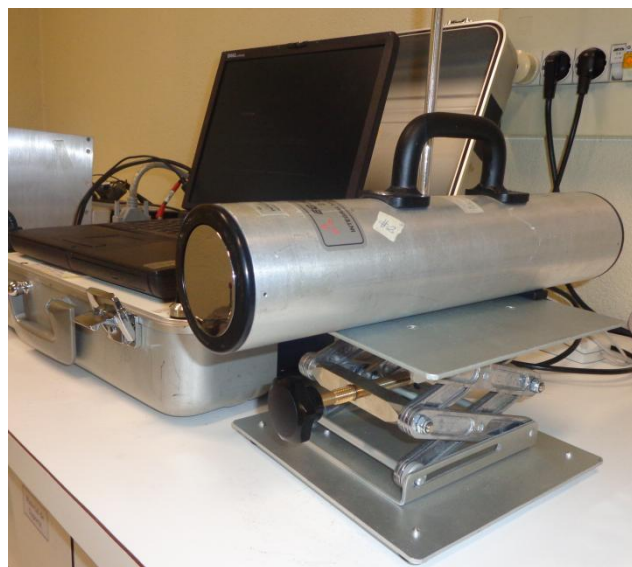
FIGURA 10 - DETECTOR DE NaI(Tl), SUPORTE AJUSTÁVEL E COMPUTADOR PORTÁTIL.
