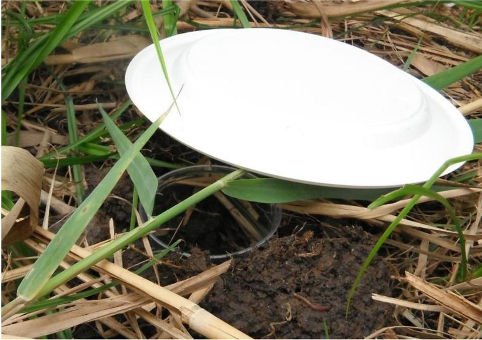
**Figura 8** – Armadilha de queda composta por um copo de plástico com etanol 62% no interior, coberta com um prato de plástico.
