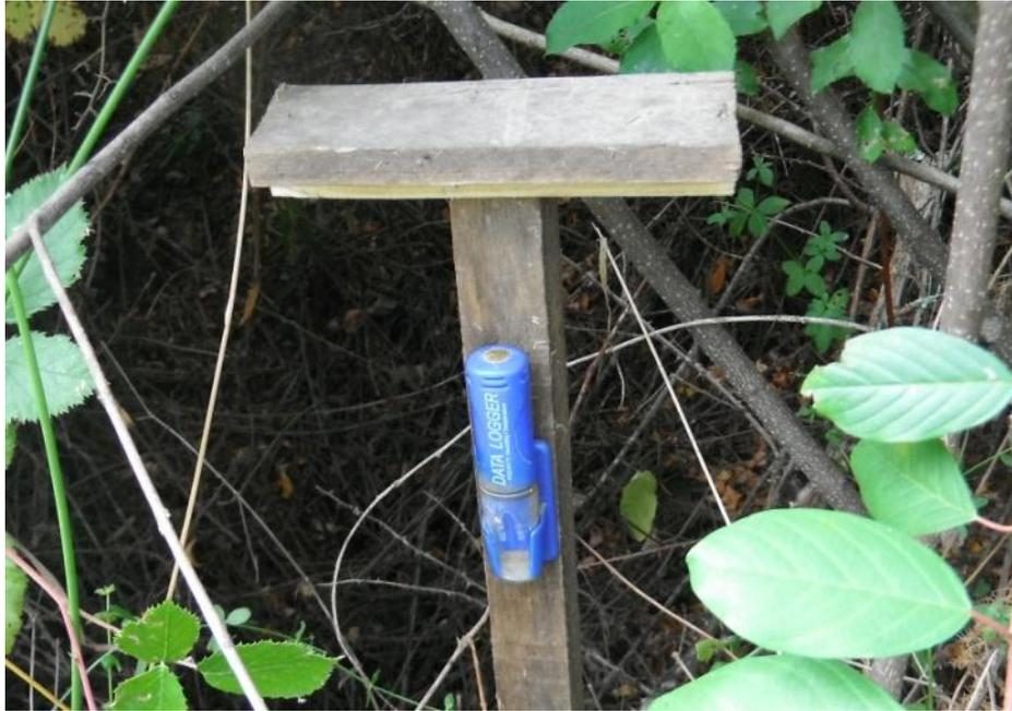
**Figura 10** – Datta logger utilizado nos registos da temperatura, colocado no suporte de madeira no interior da vegetação a cerca de 40 cm do solo.
