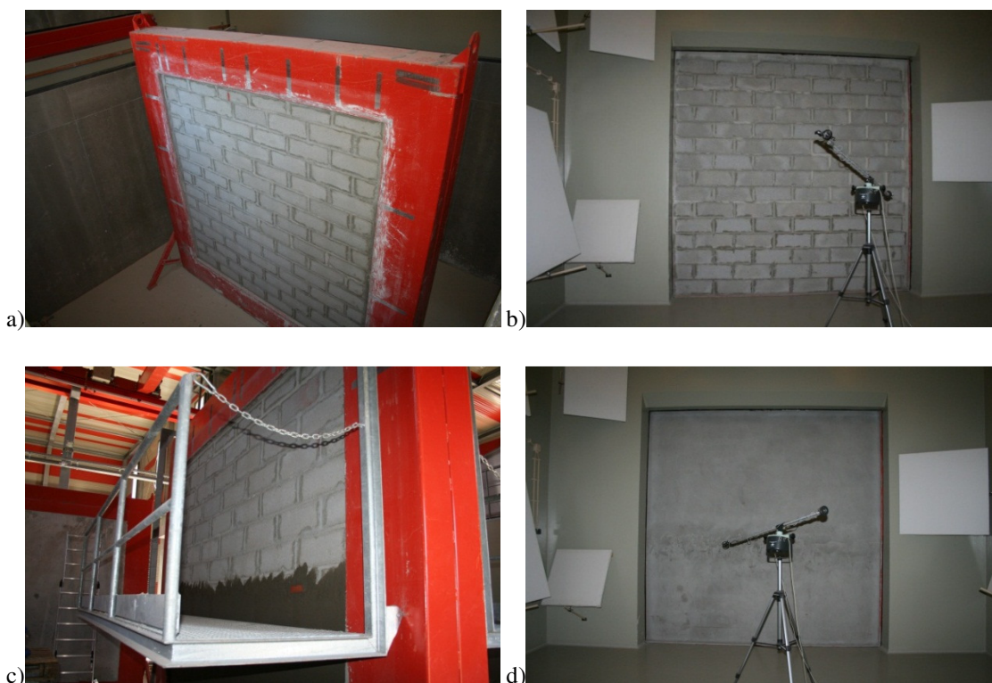
Figura 6.15: Ensaio experimental da parede de alvenaria composta por blocos com incorporação de aglomerado de cortiça expandida: a) Execução final do paramento vertical; b) Instalação do provete no interior das câmaras horizontais para realização dos ensaios laboratoriais; c) Início da execução de reboco, com argamassa de cimento com regranulado de cortiça; d) Instalação do provete rebocado no interior das câmaras horizontais para realização dos ensaios laboratoriais.
