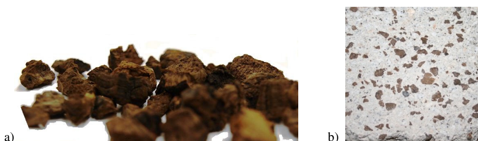
Figura 6.11: Mistura de betão com incorporação de regranulado de cortiça expandida, na fabricação de blocos de cimento: a) agregado em granel; b) corte transversal de um cubo betonado com a nova mistura leve.
