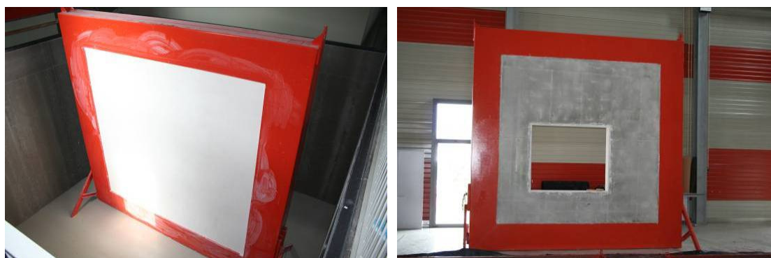
Figura 5.6: Aspecto dos aros de provetes de ensaio: aro com provete de alvenaria revestida a gesso projectado para ensaio (à esquerda); aro usado para ensaio de isolamento a sons aéreos de janelas e envidraçados (à direita).
