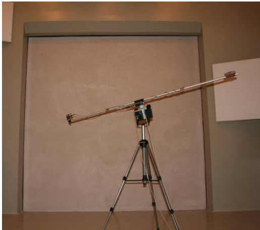
Figura 5.21: Parede do tipo B: imagem real do provete instalado entre as câmaras horizontais; esquema transversal da composição do provete de alvenaria leve: 2 placas de gesso cartonado de 12.5 mm, com juntas desencontradas, barradas e calafetadas, em todas as camadas (1); caixa de ar com 170 mm (2); lã de rocha de 30 mm com uma massa volúmica de 70\text{kg/m}^3 (3); blocos de betão em argila expandida de 150 mm, com juntas de argamassa de 12.5 mm, aproximadamente, com um peso total de 82\text{kg/m}^2 (4); reboco de argamassa com 20 mm de espessura, com uma massa superficial de 24\text{kg/m}^2 (5).
