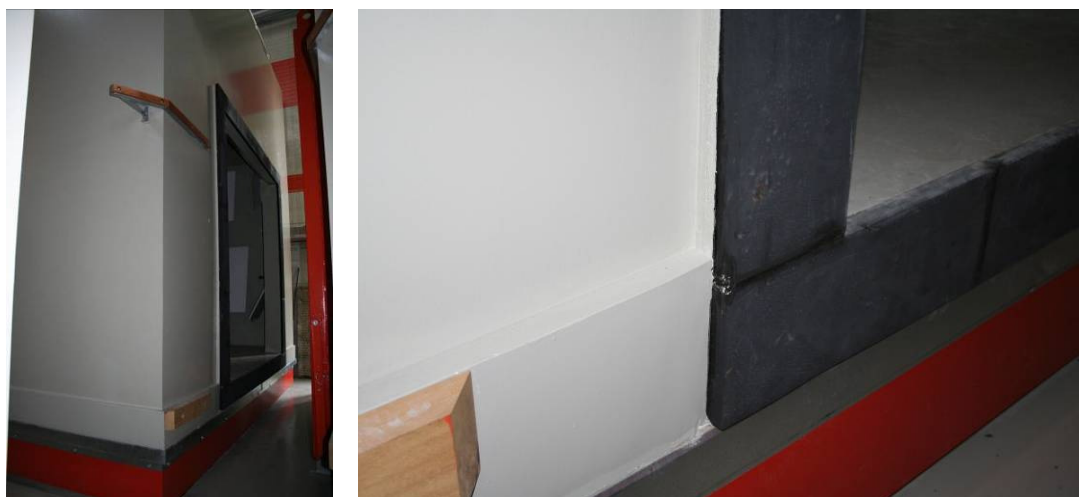
Figura 5.7: Zona onde se insere o aro do provete de ensaio na câmara horizontal móvel: aspecto geral, na primeira imagem; pormenor das bandas de isolamento para encosto dos aros, na segunda imagem.
