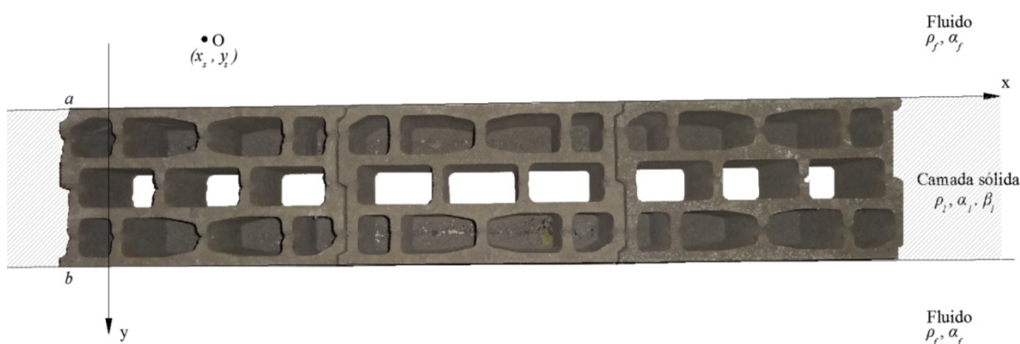
Figura 6.1: Geometria bidimensional (em corte) de uma camada sólida (blocos de betão com regranulado de cortiça expandida) infinita no plano xz , limitada por dois meios fluidos semi-infinitos.
