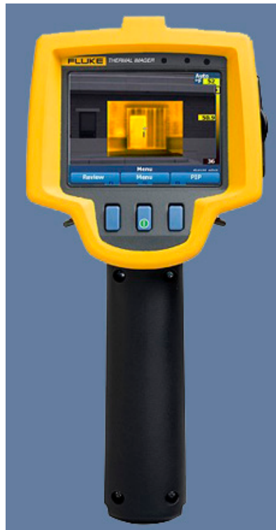
Figura 11 | Câmara termográfica. A análise termográfica procura detectar a existência de incoerências nos padrões de temperatura dos elementos da construção, que indiciam a existência de problemas.
