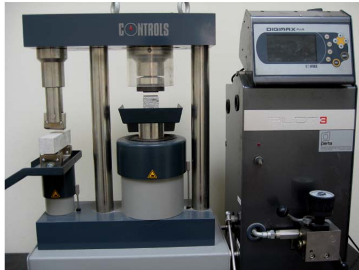
Figura 14: Equipamento utilizado para os ensaios do índice de atividade. Cortesia: LGMC|ISEP
