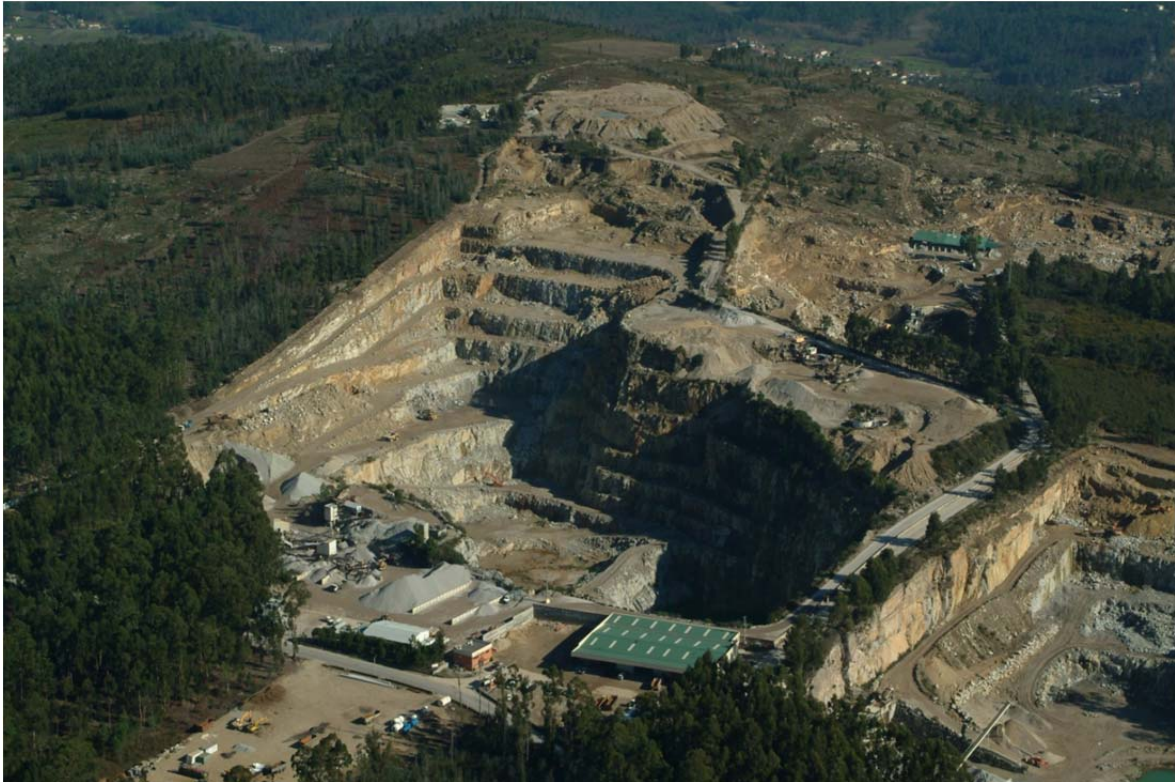
Figura 21: Pedreira de Cervães. (Na parte superior da fotografia é visível um dos depósitos de argila resultante da produção de areia)
