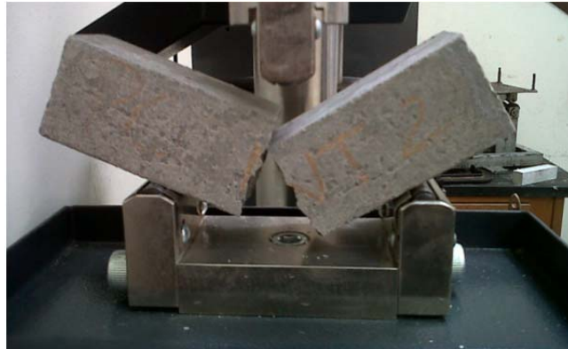
Figura 16: Obtenção dos meios primas do ensaio à Flexão. Cortesia: LGMC|ISEP
