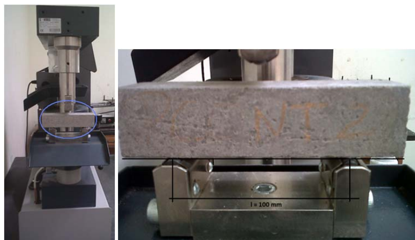
Figura 15: Ensaio à flexão. Cortesia: LGMC|ISEP
