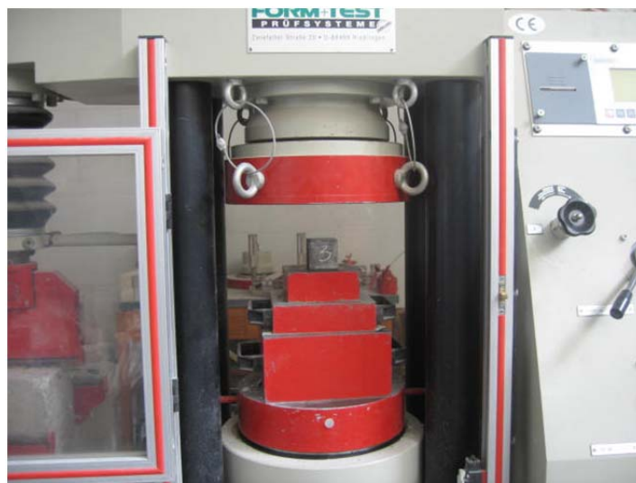
Figura 19: Equipamento para avaliar a resistência à compressão. Cortesia: LGMC|ISEP
