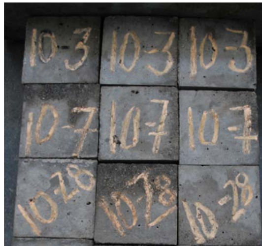
Figura 18: Provetes desmoldados e identificados com a idade do teste. Cortesia: LGMC|ISEP
