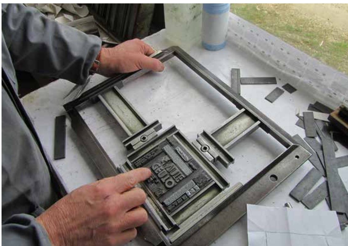
Fig. 259 – Preparação da composição tipográfica para a máquina impressora.
