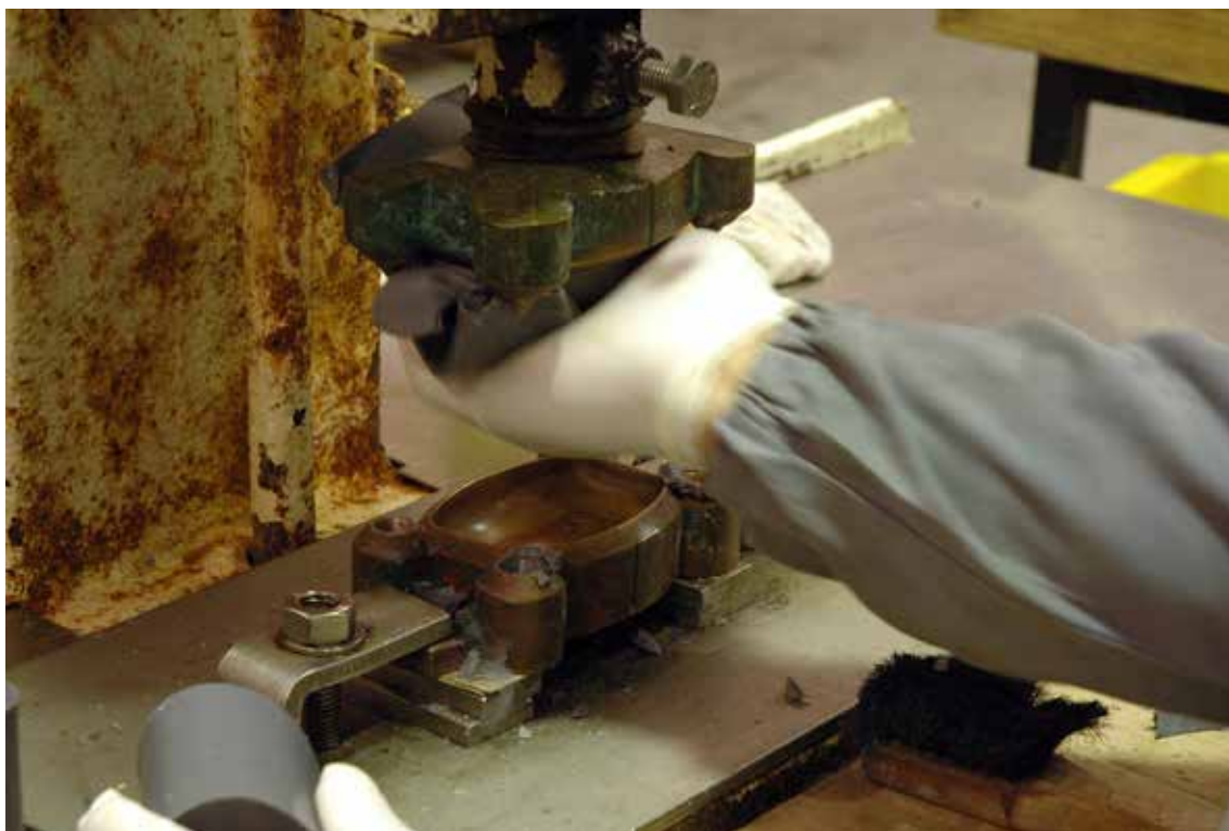
Fig. 117 – Processo de fabrico de sabonetes – Cunhagem.
