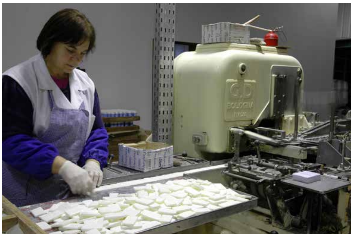
Fig. 130 – Fabrico de sabonetes miniatura com cunhagem automática.
