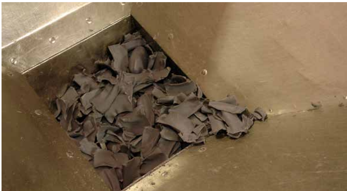
Fig. 111 – Processo de fabrico de sabonetes – Laminagem.
