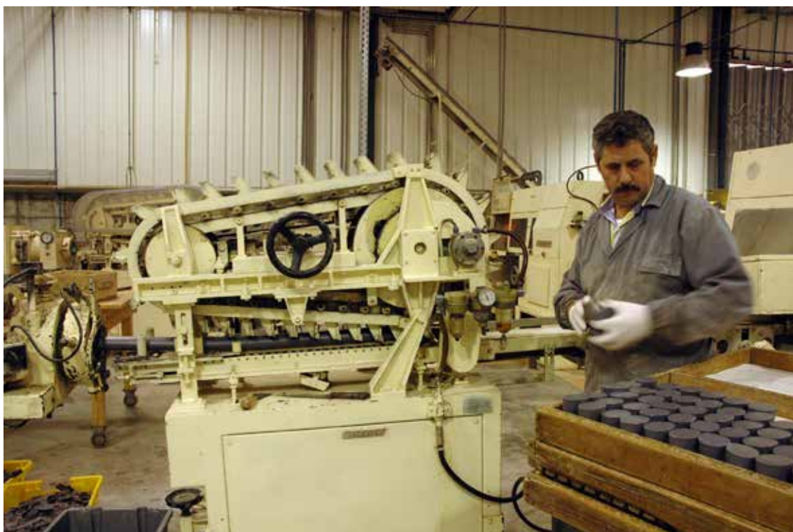
Fig. 113 – Processo de fabrico de sabonetes – Corte.
