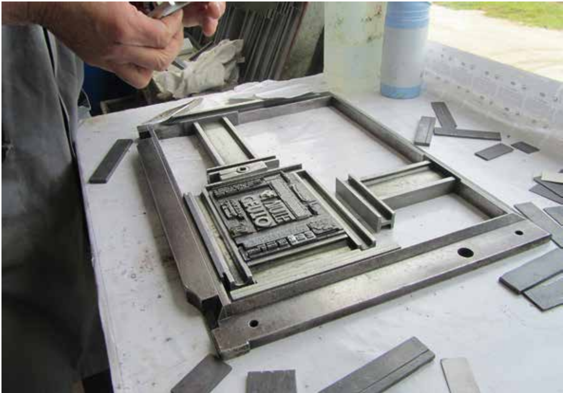
Fig. 257 – Preparação da composição tipográfica para a máquina impressora (matriz).
