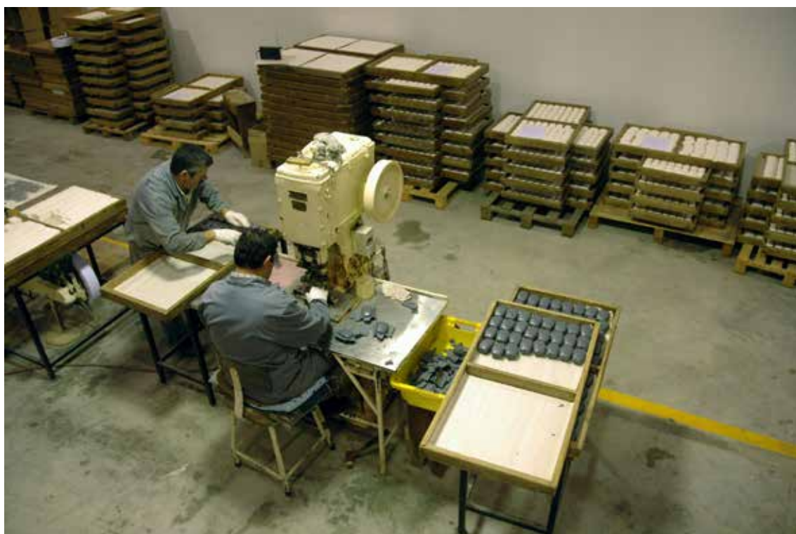
Fig. 114 – Processo de fabrico de sabonetes – Cunhagem.
