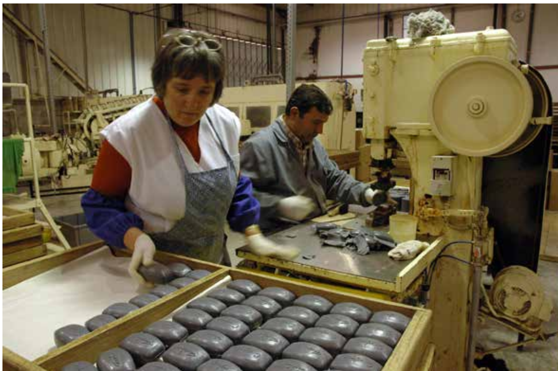
Fig. 121 – Processo de fabrico de sabonetes – Colocação de sabonetes em tabuleiros de madeira a fim de serem levados para a fase de cura.
