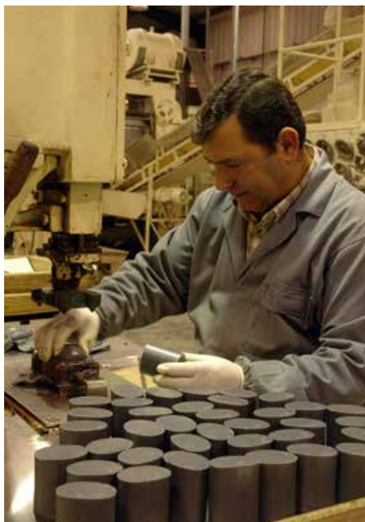
Fig. 115 – Processo de fabrico de sabonetes – Cunhagem.
