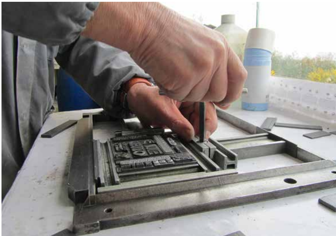
Fig. 258 – Preparação da composição tipográfica para a máquina impressora.
