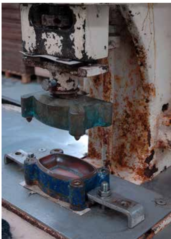
Fig. 118 – Processo de fabrico de sabonetes – Cunho colocado na máquina (à esquerda).
