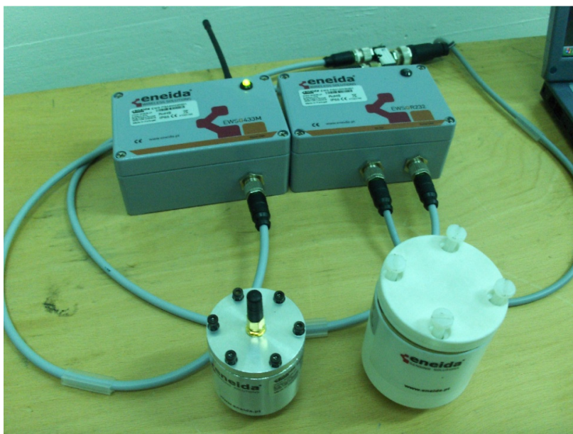
Figura 139 - Sistema de monitorização de pontos quentes em barramentos. Preparação para instalação, o sensor à esquerda tem uma caixa especial, em plástico, para instalação sobre o barramento de alta tensão.
