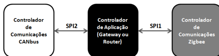
Figura 82 - Interfaces da gateway ZigBee para AP e Routers .
