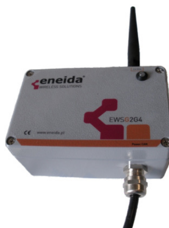
Figura 147 - Gateway de comunicações CANbus - ZigBee.
