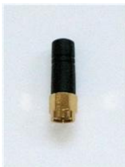
Figura 103 - Antena compacta para sensores, nos 2.4 GHz.
