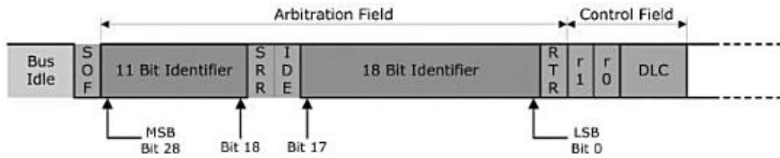
Figura 38 - - trama CANbus com Extended Identifier (69).
