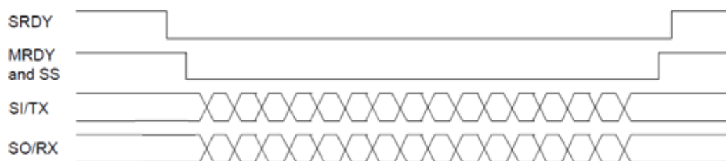
Figura 78 - Comunicação SPI iniciada por slave .
