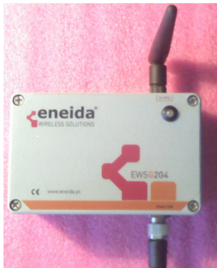
Figura 98 - Caixa da unidade G2G4. É visível a antena (em cima, à direita) e o cabo CANbus (em baixo, à direita).
