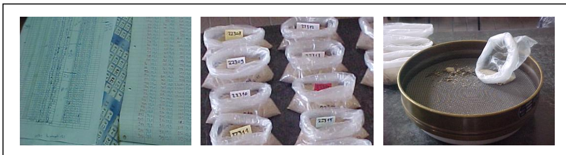
Figura III.16 – Preparação das amostras no laboratório de solos
