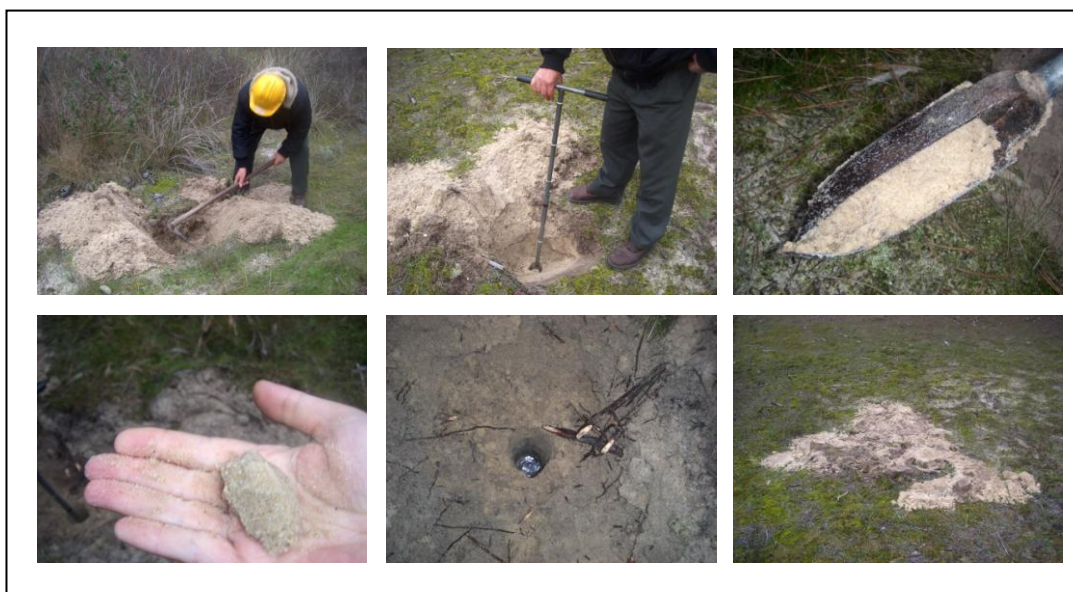
Figura III.9 – Medição da profundidade da toalha freática no campo
