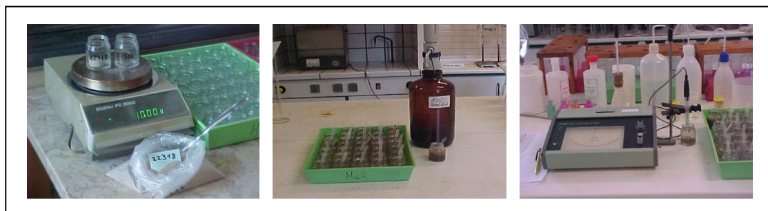
Figura III.17 –Determinação do pH em H 2 O pelo método potenciométrico
