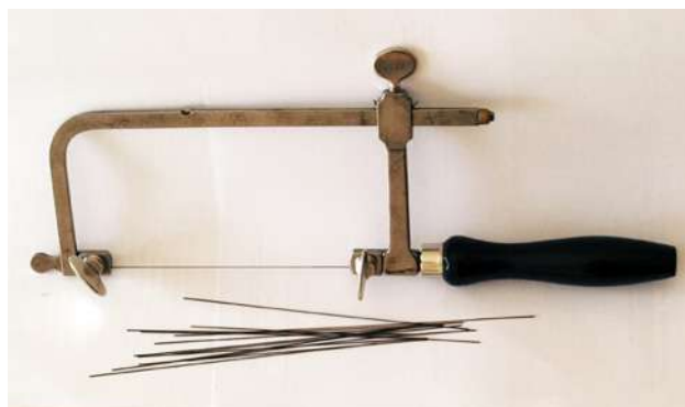
Fig. 6: Serra manual utilizada para a remoção das amostras
