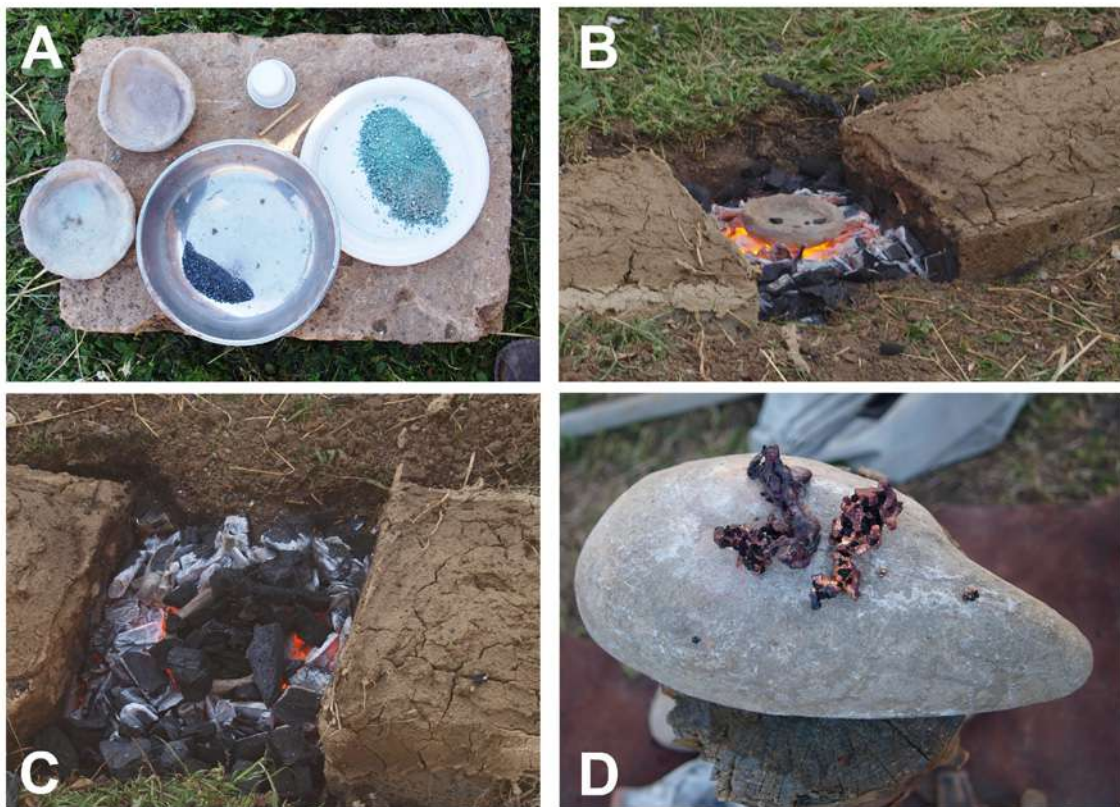
Fig. 165: Reconstrução experimental do processo de co-redução em estruturas de vasilhas de redução (Blera, Itália, 2011). A: duas vasilhas de redução e minérios de estanho (cassiterita) e de cobre (malaquite) triturados para serem misturados num processo de co-redução; B: vasilha de redução colocado no “forno”; C: vasilha de redução e minérios progressivamente cobertos por carvão; D: nódulos de cobre resultantes da produção primária.
