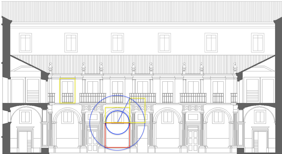
Proporções no alçado do Claustro dos Agostinhos em Coimbra– esquema do autor
