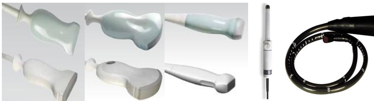
Figura 13 – Transdutores: linear, convexo, phased-array e endocavidades [2].
