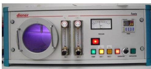
Figura 32: Imagem da técnica de modificação das membranas por Plasma.
