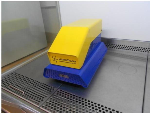
Figura 3.2 – Equipamento *LigandTracer*, utilizado para a realização de estudos de captação.
