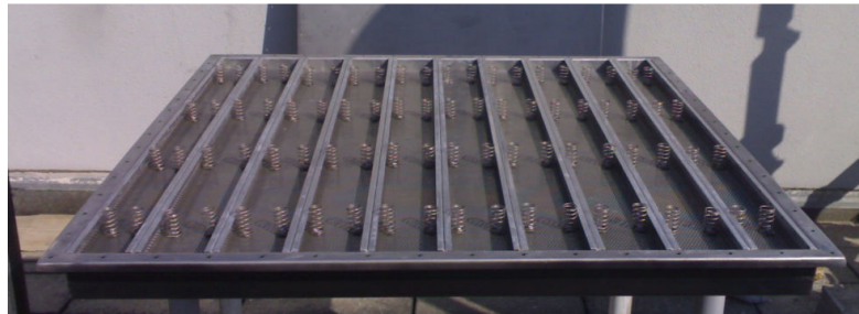
Figura 3.2 – Fotografia da caixa do adsorvedor em posição invertida, mostrando as alhetas de reforço, tabuleiros da sílica-gel, molas de compressão, e flange lateral aparafusada (no modelo inicial).
