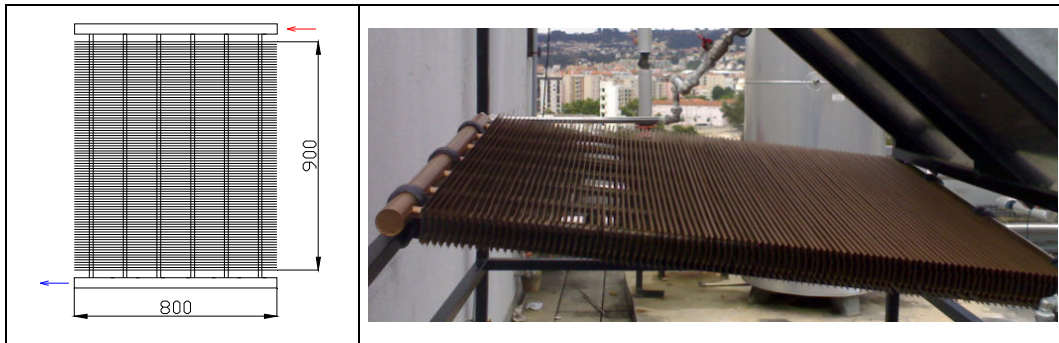
Figura 3.3 – Esquema e foto do condensador. Dimensões em [mm].
