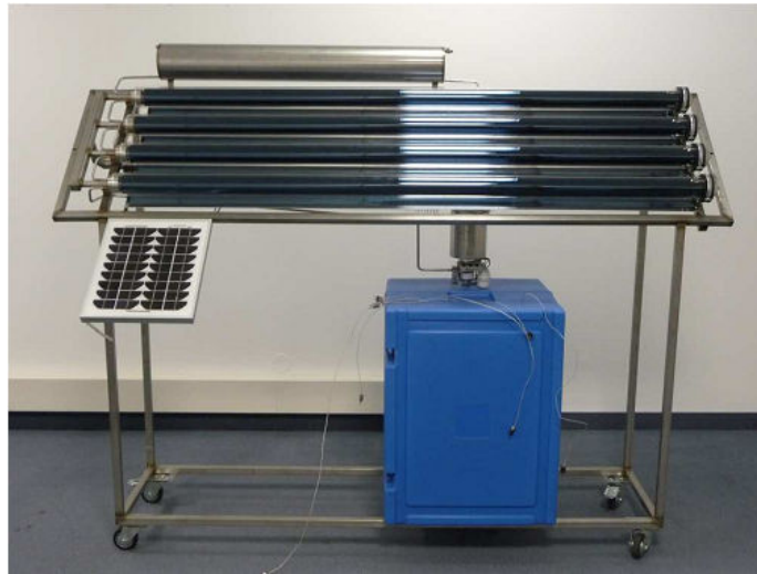
Figura 1.13 – Máquina de produção de gelo com energia solar, patenteada em 2011 pela empresa alemã Zeo-Tech, e ainda em fase de aperfeiçoamento (Zeo-Tech, 2011).
