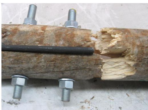
Figura 6.26 – Rotura por tracção na madeira (esq.) e rotura devido a formação de fendas (dir.)
