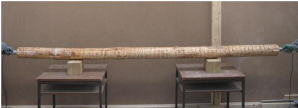
Figura 4.10 – Execução do método dos ultrasons
