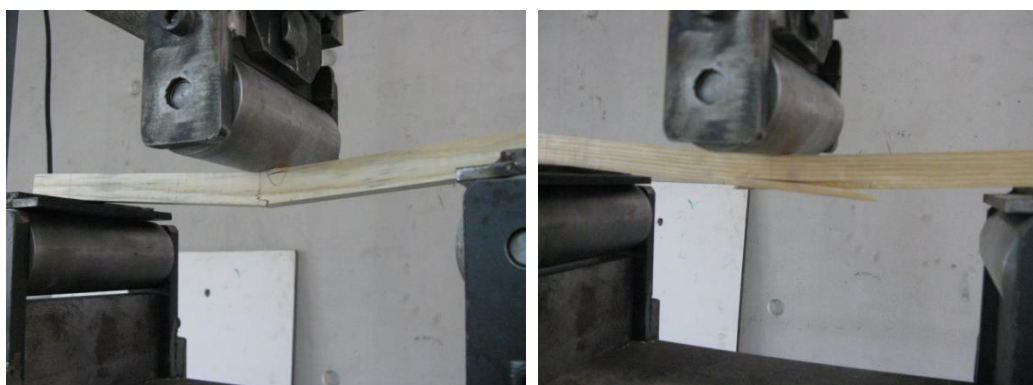
Figura 3.34 – Roturas das peças de madeira limpa em tração na zona central
