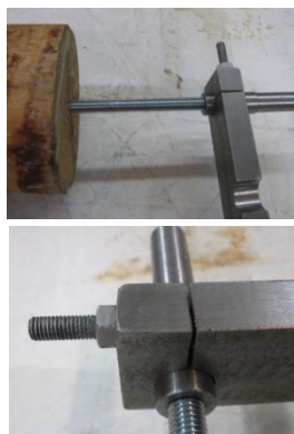
Figura 6.31 – Sistema de medição de deslocamentos nas ligações de sistema de ancoragem
