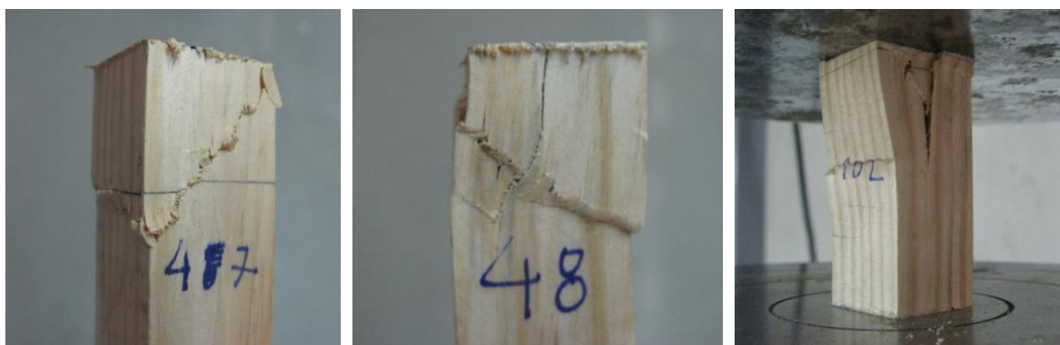
Figura 3.37 – Exemplos de roturas no ensaio de compressão de provetes de madeira limpa
