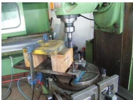
Figura 3.13 – Maquinação dos blocos de madeira
