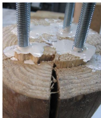
Figura 6.48 – Rotura pela madeira, numa ligação de varões colados
