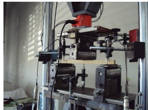
Figura 5.47 – Ensaio das peças de madeira limpa dos postes
