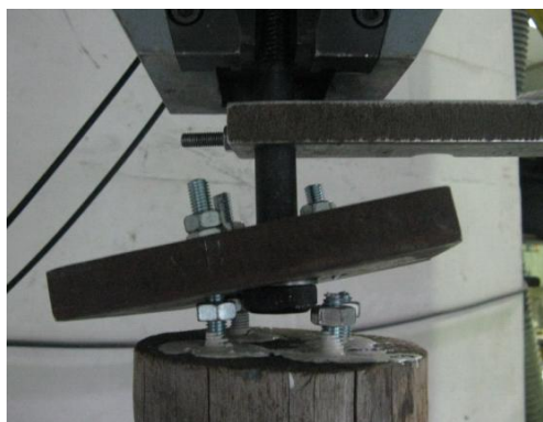
Figura 6.47 – Rotura pelos varões, numa ligação de varões colados
