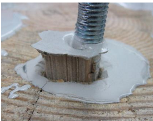
Figura 6.37 – Rotura pela madeira
