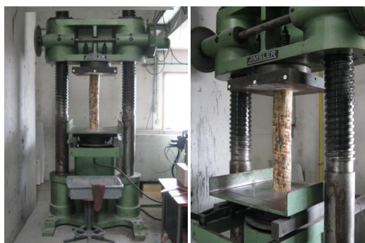
Figura 3.22 – Ensaio de compressão de provetes de toros
