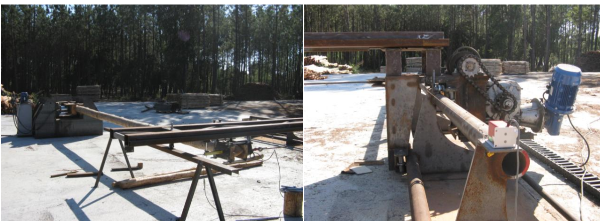
Figura 5.43 – Dispositivo de ensaio de flexão dos postes
