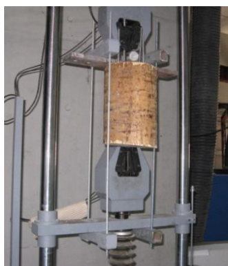
Figura 6.35 – Ensaio de arrancamento
