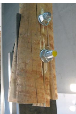
Figura 6.26 – Rotura por tracção na madeira (esq.) e rotura devido a formação de fendas (dir.)
