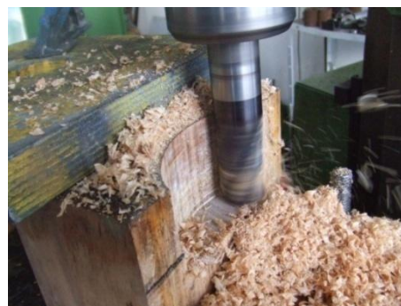
Figura 3.13 – Maquinação dos blocos de madeira
