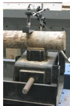
Figura 3.16 – Medições nos apoios
