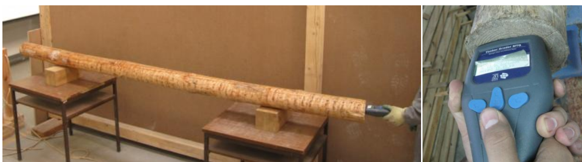
Figura 4.8 – Equipamento de vibração longitudinal, Timber Grader MTG, e sistema de apoio dos toros
