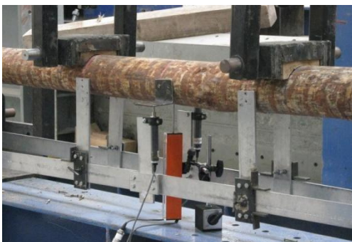
Figura 3.15 – Medições a meio vão
