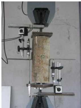
Figura 6.44 – Ligação de varões colados colocada na prensa de ensaio
