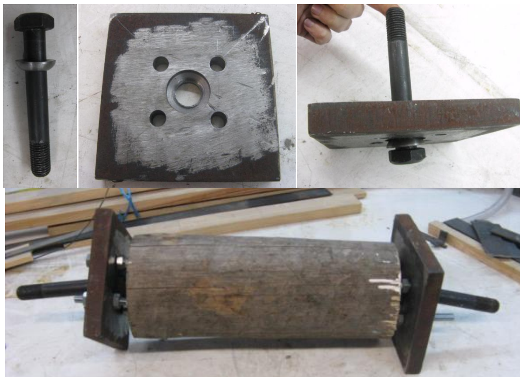
Figura 6.43 – Cabeçote aplicado às ligações de varões colados
