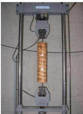
Figura 6.30 – Ligação de sistema de ancoragem colocada na prensa de ensaio
