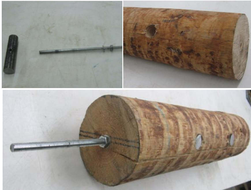
Figura 6.29 – Ligação de sistema de ancoragem estudada
