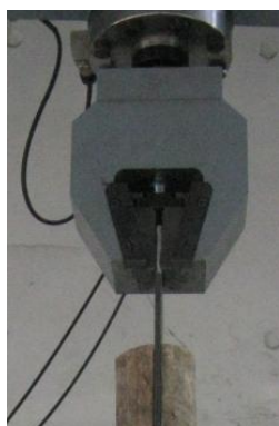
Figura 6.20 – Pormenor da colocação de uma ligação de chapa central na prensa de ensaio
