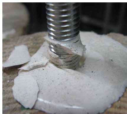
Figura 6.38 – Rotura pela cola
