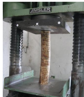
Figura 3.25 – Rotura devido à curvatura da peça
