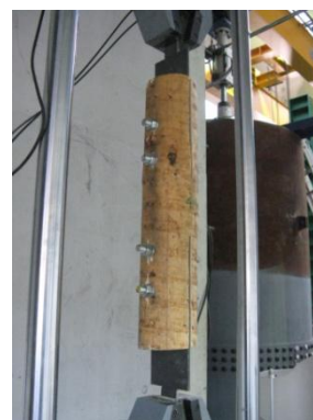
Figura 6.21 – Ligação de chapa central colocada na prensa de ensaio
