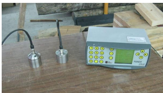
Figura 4.9 – Equipamento de ultra sons, Pundit Plus
