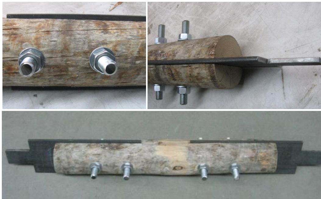
Figura 6.19 – Ligação de chapa central estudada
