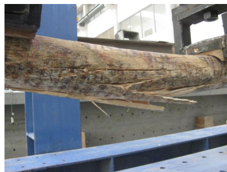
Figura 3.21 – Rotura a meio vão
