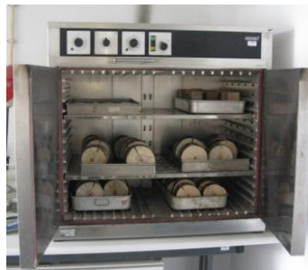
Figura 3.26 – Secagem das rodela dos toros
