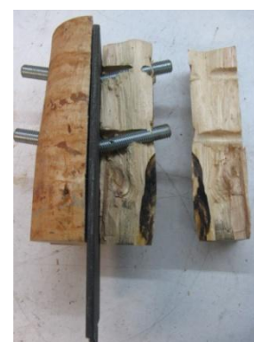
Figura 6.27 – Rotura com plastificação dos ligadores
