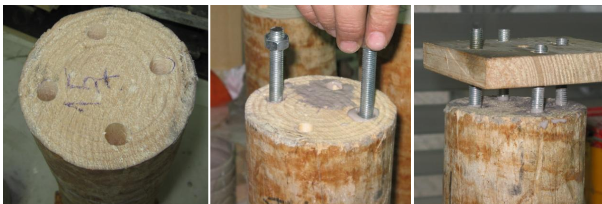
Figura 6.41 – Elaboração da ligação de varões colados
