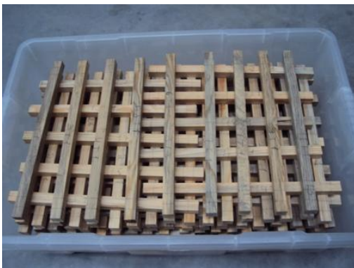
Figura 5.46 – Amostras recolhidas dos postes para posterior imersão em água
