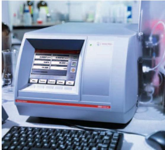
**Figura 5.1.-** Densímetro Anton Paar, modelo DMA 5000, utilizado para medir la densidad de los líquidos.
