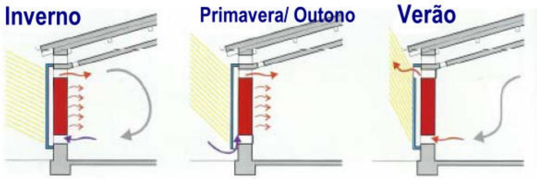
Fig. 12 - Parede de trombe
