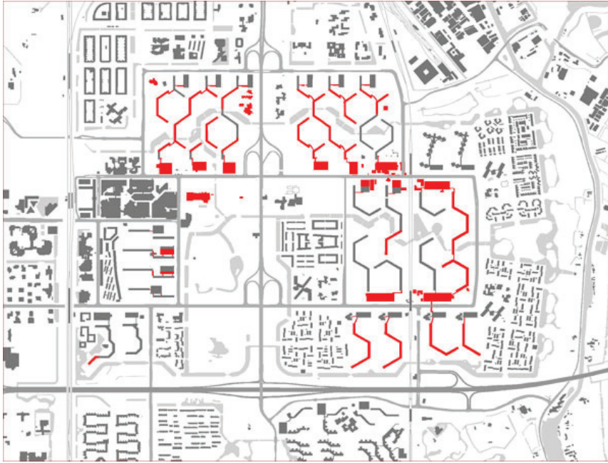
Figura 127 Planta do Bijlmermeer antes das obras: os edifícios a vermelho foram demolidos
