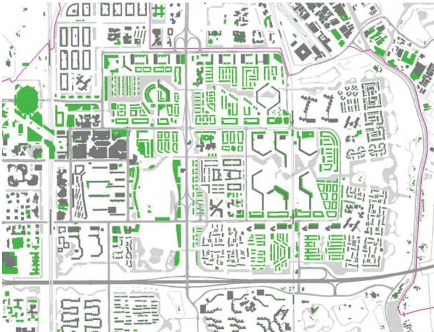
Figura 128 Planta das intervenções: note-se a densificação da malha urbana e a reconfiguração das ruas
