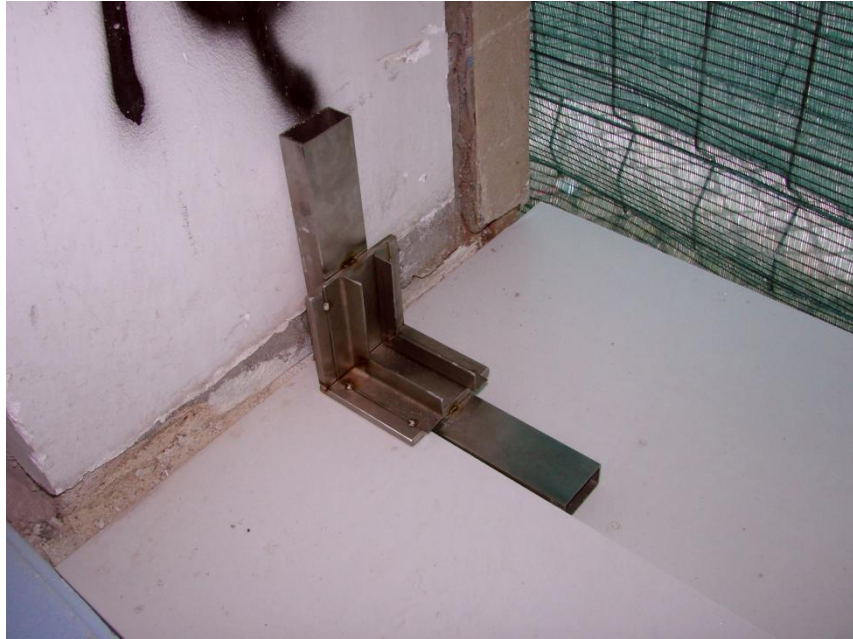
Protótipo da caixilharia (cantoneiras soldadas, em vez de aparafusadas)
