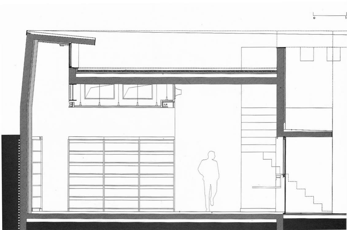
Fig. 83 - Corte pela sala de leitura - relações com o exterior e entradas de luz
