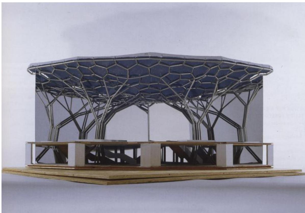
↑ Fig.162 Modelo suspenso utilizado para calcular a forma da estrutura ramificada do *Majilis al Shura*.
