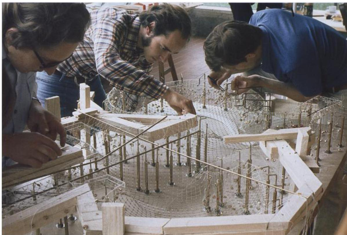
↑ Fig.152 Modelo comparativo entre uma cúpula executada com ripas de madeira e uma malha de correntes.
