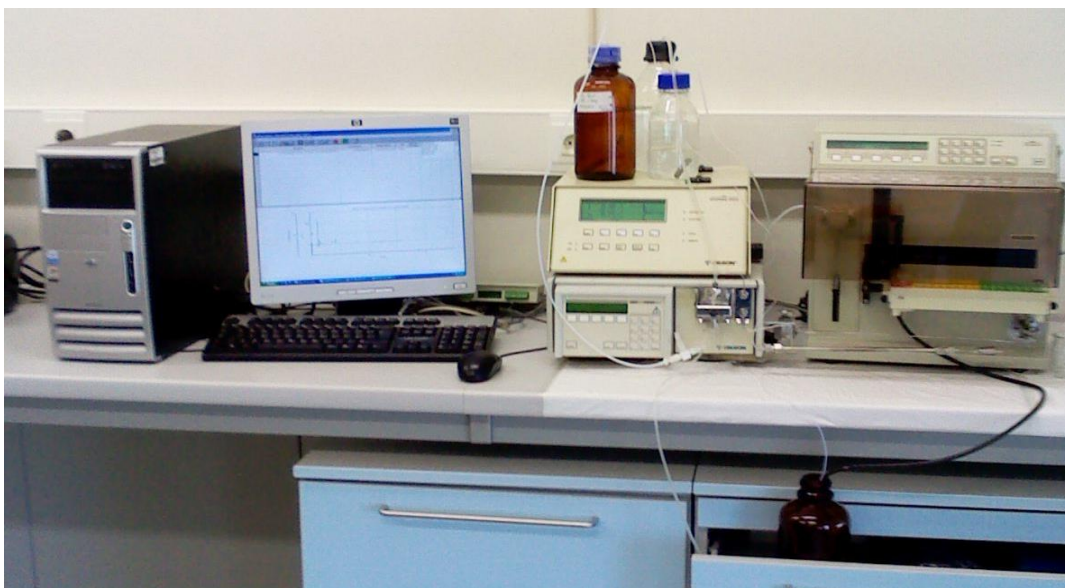
Figura 18 – Sistema de HPLC utilizado neste estudo para a quantificação de monoaminas (Fotografia tirada no Laboratório de Farmacologia e Terapêutica Experimental da Faculdade de Medicina da Universidade de Coimbra).
