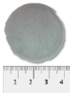
Figura 24 – Disco de carboneto de boro resultante do ensaio 6.
