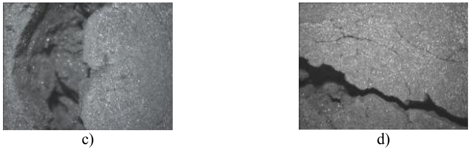
Figura 50 - Proveste 11 após compactação dinâmica
