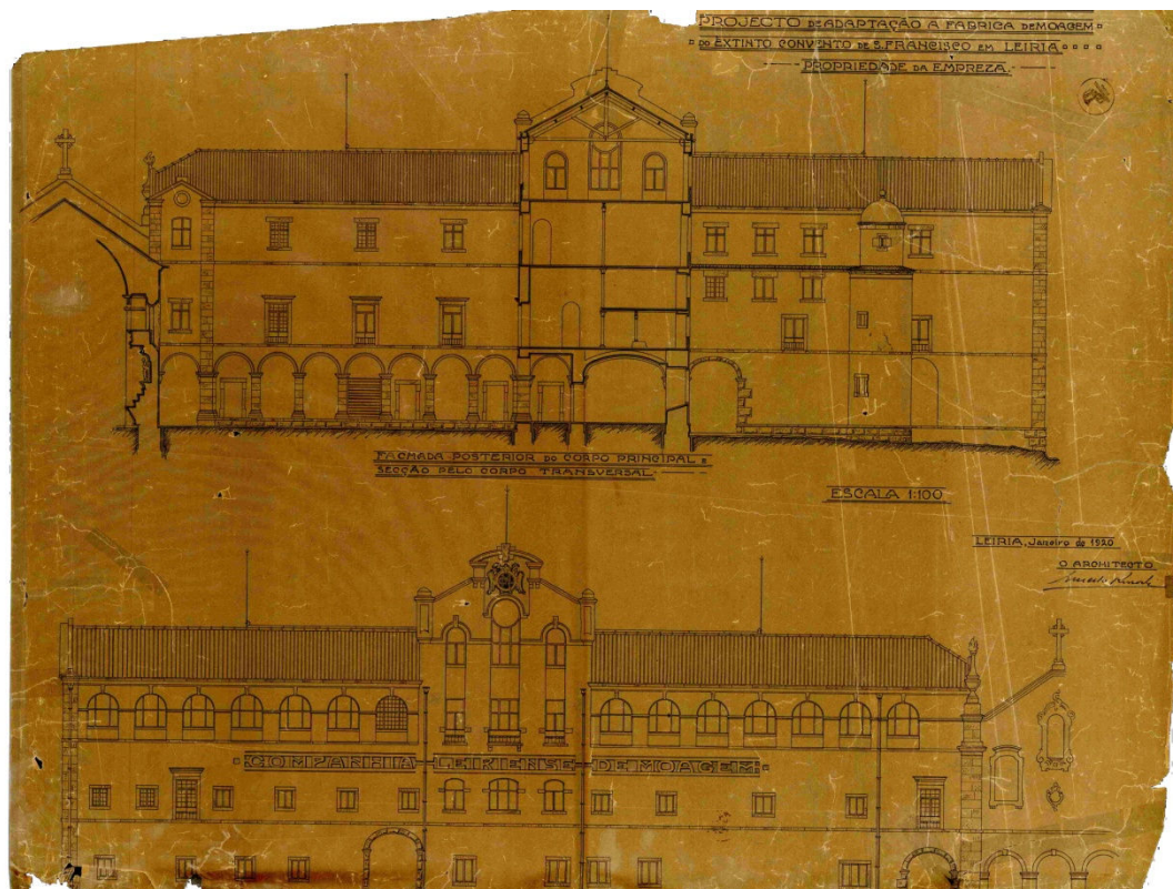
Imagem 45 – Alçados Principal e Posterior do projecto de transformação do convento em moagem.
