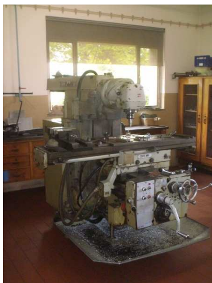
Figura 3.3. Fresadora Universal Cincinnati Milacron 207 MK.
