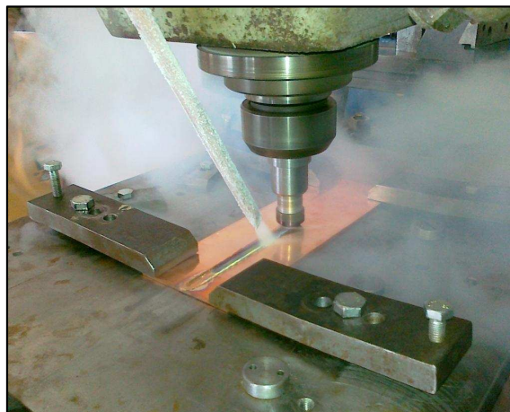
Figura 4.5. Aplicação de azoto líquido sobre a zona processada.
