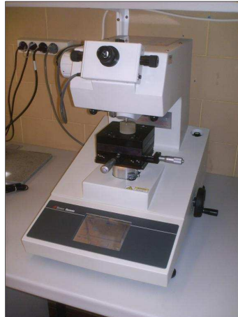
Figura 3.6. Microdurómetro Struers Duramin – Microhardness Tester
