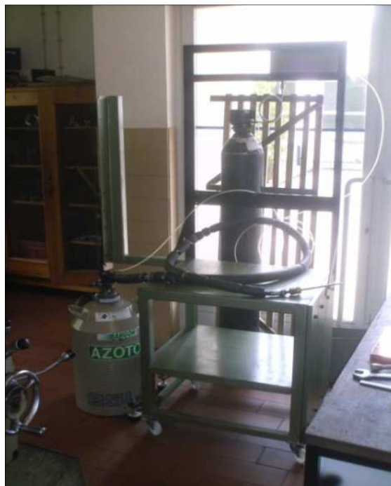
Figura 3.7. Sistema de arrefecimento com azoto líquido.
