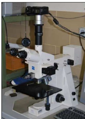
Figura 3.4. Microscópio óptico ZEISS Axiotech 100HD com máquina fotográfica Canon Powershot G5 acoplada.
