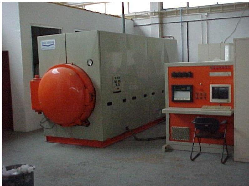
Figura 10 Um dos sistemas para processamento de laminados em autoclave, no INEGI-Porto.
