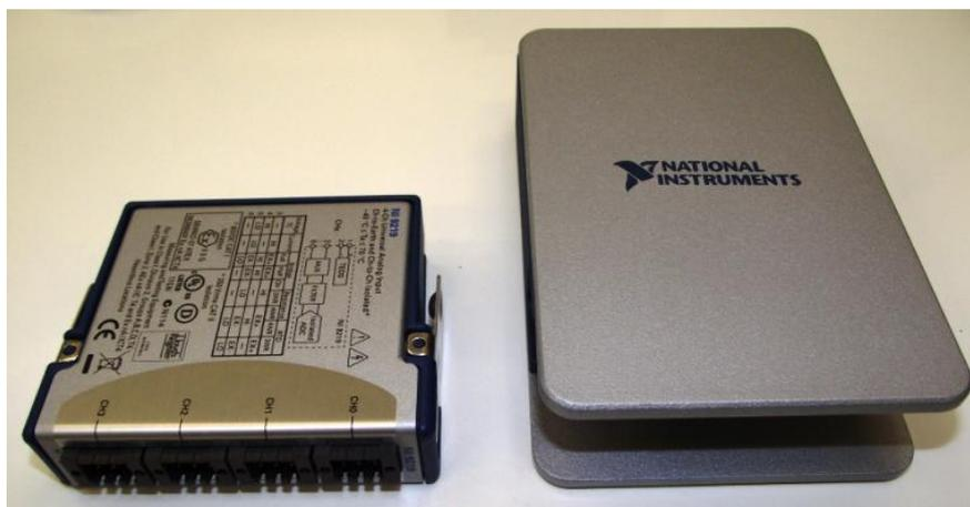
Figura 23 Placa de aquisição de dados e respetivo “chassis” da marca *National Instruments*.
