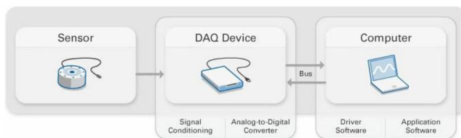
Figura 27 Esquema da *NI* representativo da lógica da aquisição de dados.
