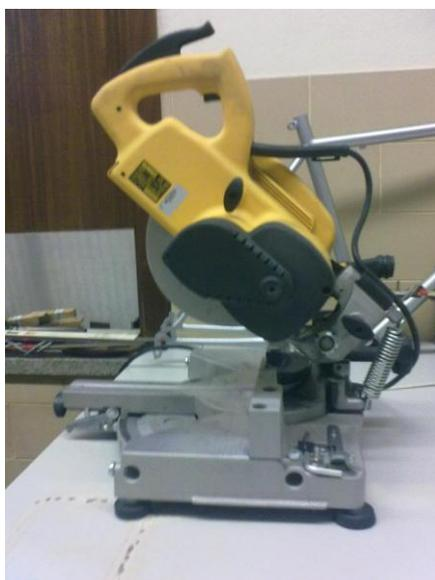
Figura 11 Serra de disco de dentes diamantados para corte dos laminados.
