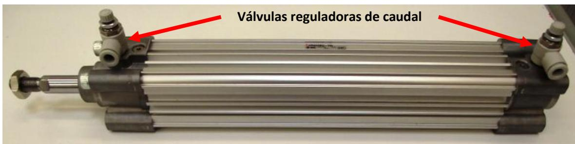
Figura 15 Atuador pneumático da marca *SMC* e respetivas válvulas reguladoras de caudal.
