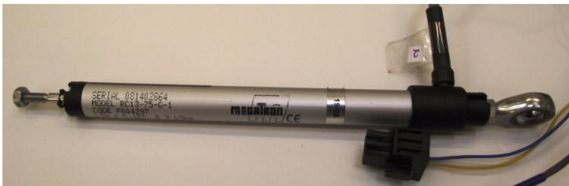
Figura 21 Sensor de deslocamento linear da marca *MegaTron*.
