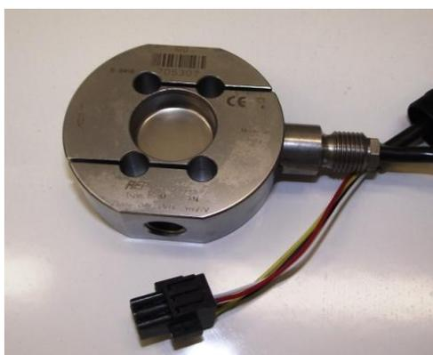
Figura 20 Célula de carga de tração-compressão da marca *AEP Transducers*.
