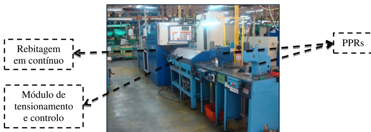
Figura 14. Rebitagem em contínuo, mód. de tensionamento e controlo, e PPRs – Linha 3
