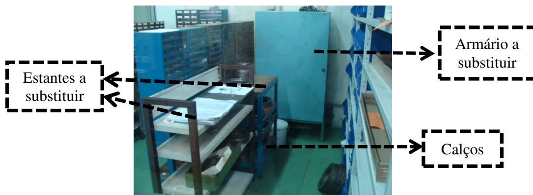
Figura 44. Estantes e armário a substituir
