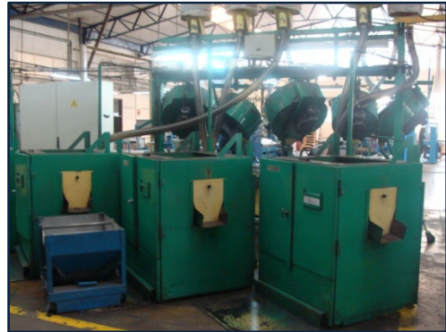
Figura 10. CHC – Transmissão de material das cubas para alimentadores
