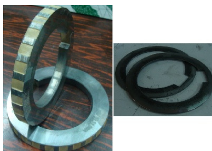
Figura 29. Exemplo de discos e calços da Rebitagem em contínuo
