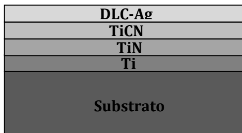
Figura 3.1. Representação esquemática da intercamada realizada no processo de deposição.
