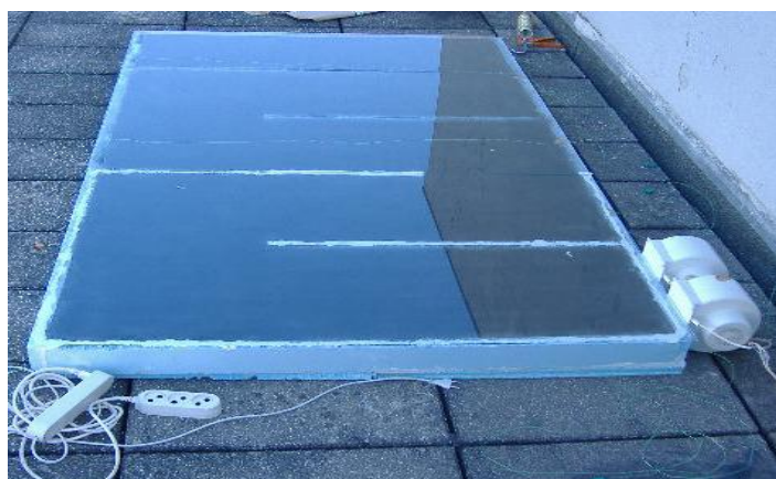
Figura 3-5 Protótipo do colector solar – vista geral (Silva et al. , 2010).
