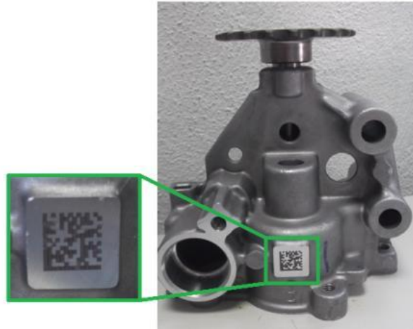
Figura 2.12. – Marcação de Data Matrix por laser numa bomba de óleo
