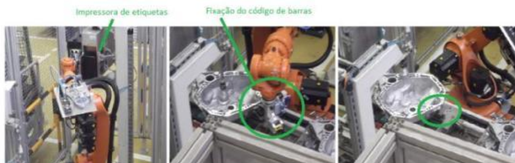
Figura 3.9. – Colagem de etiqueta no módulo 1
