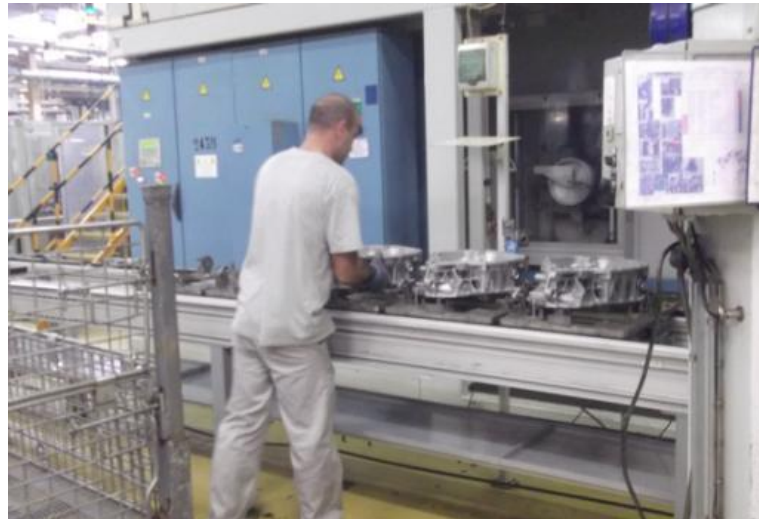
Figura 3.3. – Carregamento da linha do módulo 1
