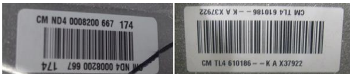
Figura 4.5. – Etiquetas código de barras usadas nos carters (À dir.: etiqueta usada nos módulos 1 e 2; À esq.: etiqueta usada nos módulos 3 e 4)
