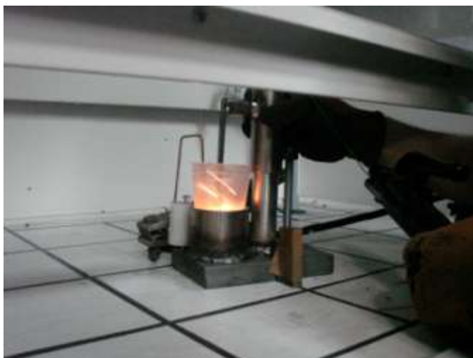
Figura 3.4. Sistema utilizado na soldadura dos termopares
