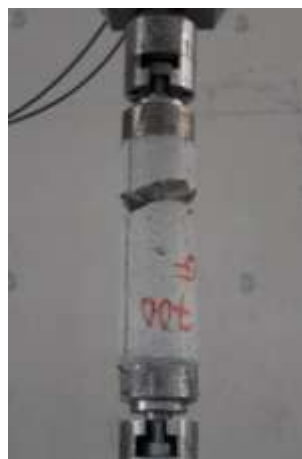
Figura AIII.21. Provete Betão Granítico – série 700°C; arrefecimento por jato de água
