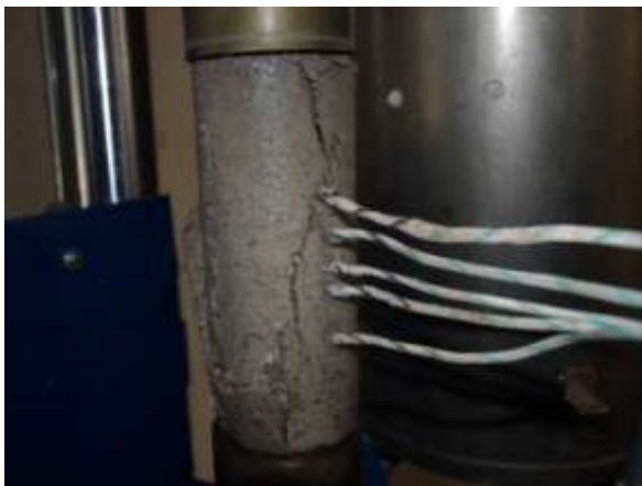
Figura AII.30. Provete Betão Granítico – série de 0,3fcd; 700°C; arrefecimento por jato de água
