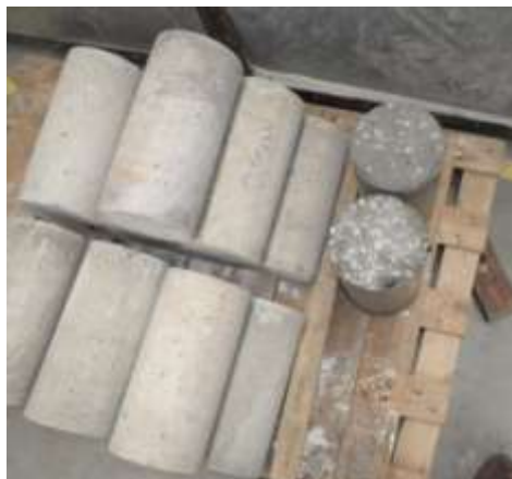
Figura 3.63. Provetes utilizados nos ensaios do módulo de elasticidade
