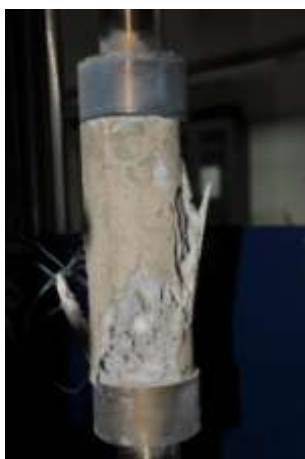
Figura AII.26. Provete Betão Granítico – série de 0,3fcd; 500°C; arrefecimento ao ar
