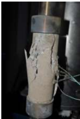
Figura AII.29. Provete Betão Granítico – série de 0,3fcd; 700°C; arrefecimento ao ar
