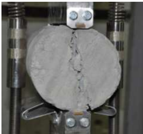
Figura AIV.12. Provete Betão Calcário – série 700°C; arrefecimento ao ar
