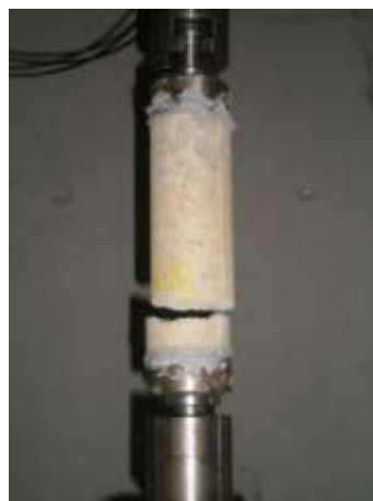
Figura AIII.11. Provete Betão Calcário – série 300°C; arrefecimento por jato de água
