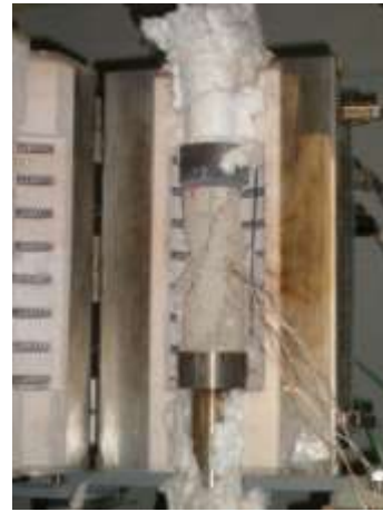
Figura AII.13. Provede Betão Calcário – série de 0,7fcd; 300°C; arrefecimento ao ar
