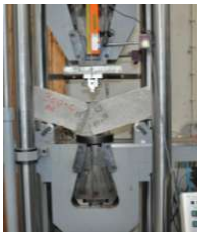
Figura AV.8. Provede Betão Calcário – série 300°C; arrefecimento ao ar
