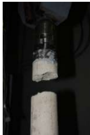
Figura AIII.19. Provete Betão Granítico – série 500°C; arrefecimento por jato de água
