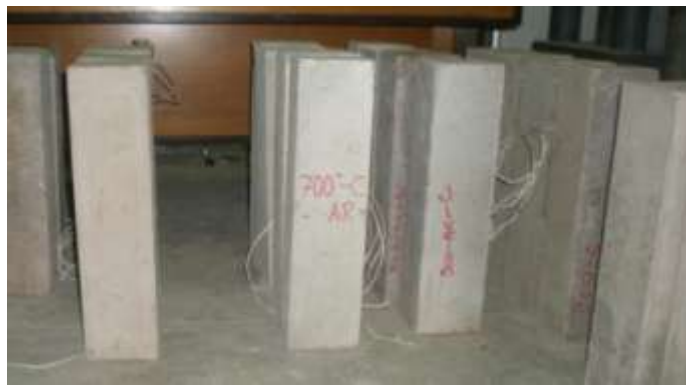
Figura 3.52. Provetes utilizados nos ensaios de resistência à flexão
