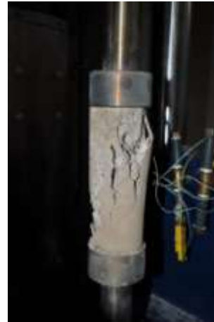
Figura AII.24. Provete Betão Granítico – série de 0,7fcd; 300°C; arrefecimento ao ar
