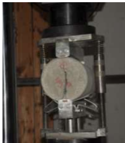
Figura AIV.9. Provete Betão Calcário – série 300°C; arrefecimento por jato de água
