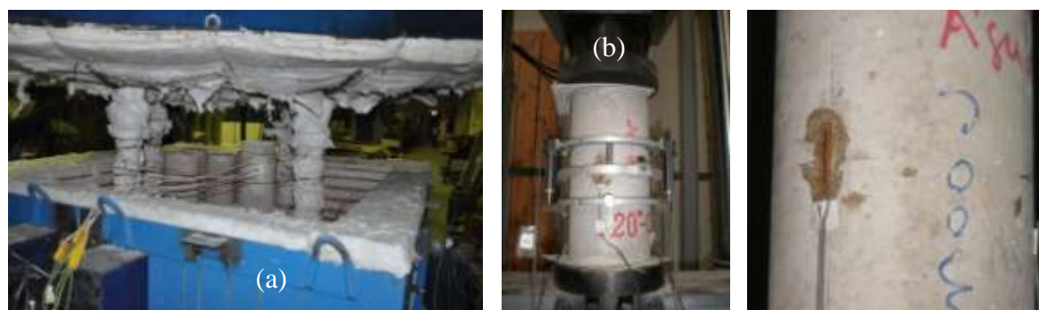
Figura 3.67. Sistema de ensaio – módulo de elasticidade
