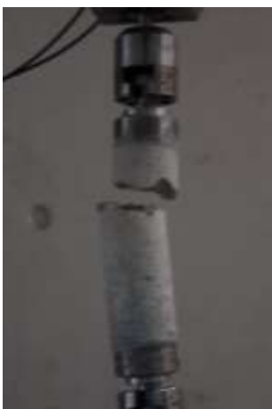
Figura AIII.12. Provete Betão Calcário – série 500°C; arrefecimento ao ar
