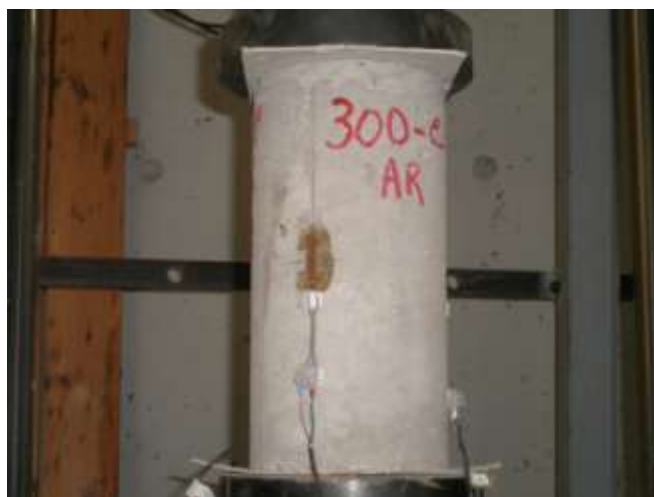
Figura 3.66. Colocação dos extensómetros nos provetes
