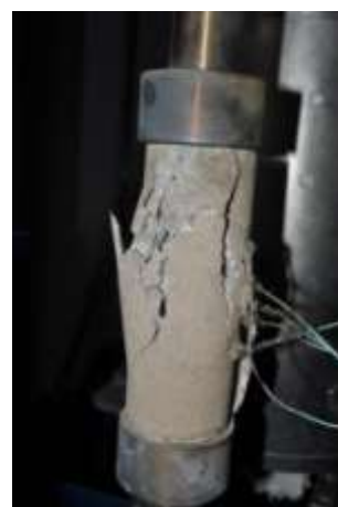
Figura AII.27. Provete Betão Granítico – série de 0,7fcd; 500°C; arrefecimento ao ar
