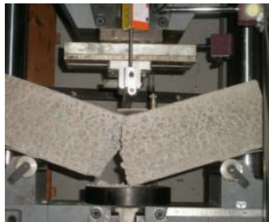
Figura AV.9. Provede Betão Calcário – série 300°C; arrefecimento por jato de água
