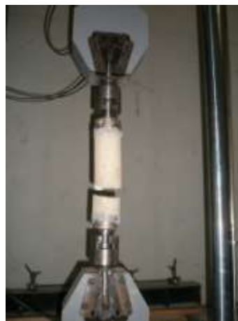
Figura AIII.13. Provete Betão Calcário – série 500°C; arrefecimento por jato de água
