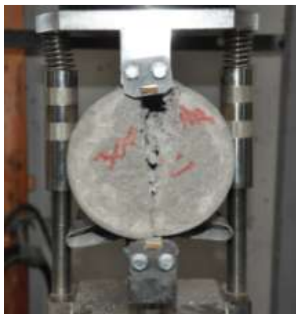
Figura AIV.8. Provete Betão Calcário – série 300°C; arrefecimento ao ar
