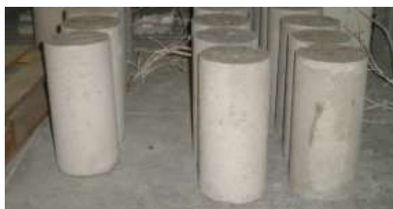
Figura 3.39. Provetes utilizados nos ensaios de tração por compressão diametral
