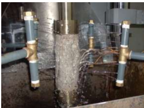
Figura AII.18. Provete Betão Calcário – série de 0,3fcd; 500°C; arrefecimento por jato de água
