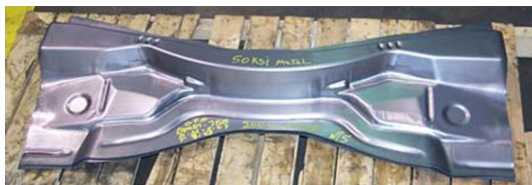
Figura 48. Componente automóvel proposto para análise no Benchmark 2 da conferência NUMISHEET 2005 [Zhang et al. , 2005].
