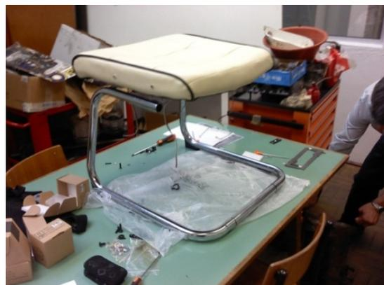
**Figura 4.** Base da cadeira com todas as células de carga localizadas e antes da ligação ao sistema de aquisição de dados.
