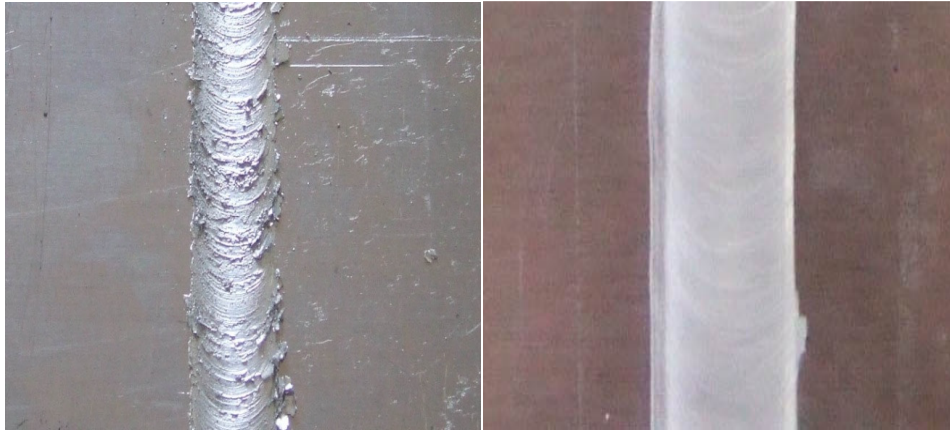
Figura 15 – Aspecto visual da soldadura efectuada com a ferramenta de ângulo da base de 2° e 5° respectivamente.
