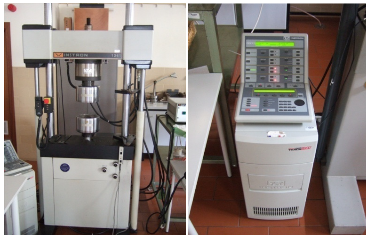
Figura 29 – Máquina de ensaios e sistema de controlo utilizados nos ensaios de fadiga.
