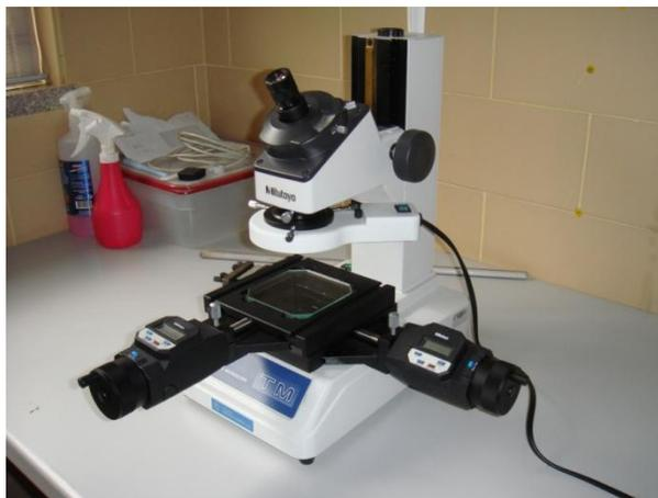
Figura 39 – Microscópio de medição
