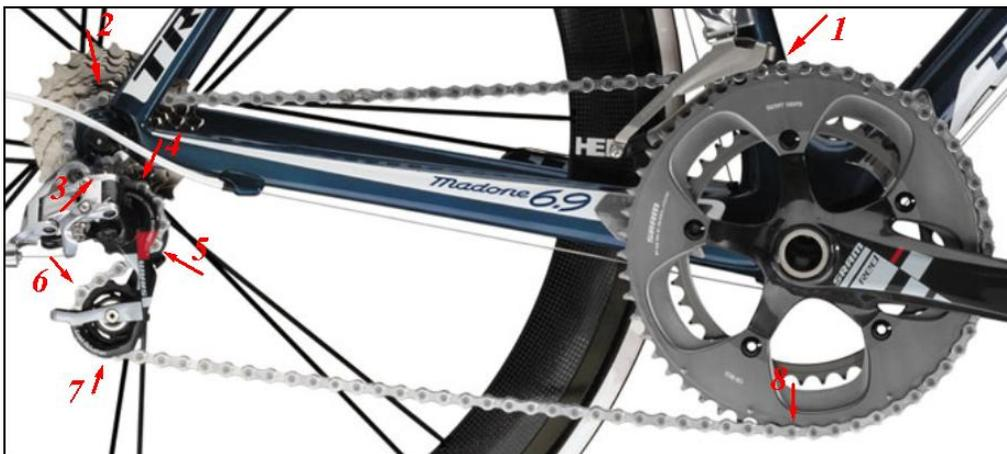
**Figura 34 – Detalhe dos pontos de engrenamento e desengrenamento**
