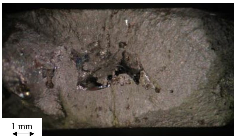
Figura 5.9 – Defeito de grandes dimensões que originou os mecanismos de fadiga.
