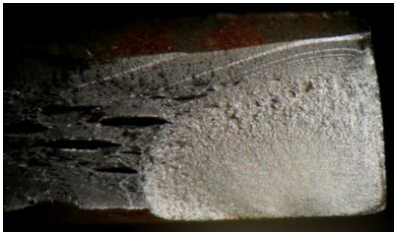
Figura 5.10 – Superfície de fractura por fadiga num provete.
