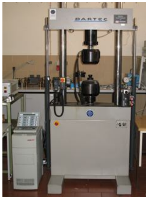
Figura 3.2 – Máquina servo-hidráulica DARTEC com capacidade até 100 KN.
