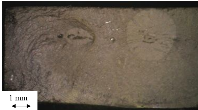
Figura 5.8 – Zonas distintas de nucleação de fendas de fadiga.
