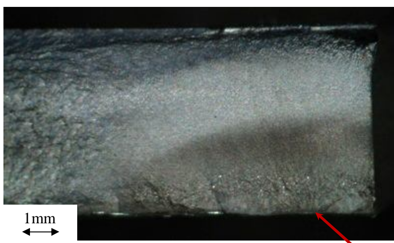
Figura 5.5 - Aspecto da superfície de fractura, sendo visíveis a zona de iniciação e propagação da fenda de fadiga.
