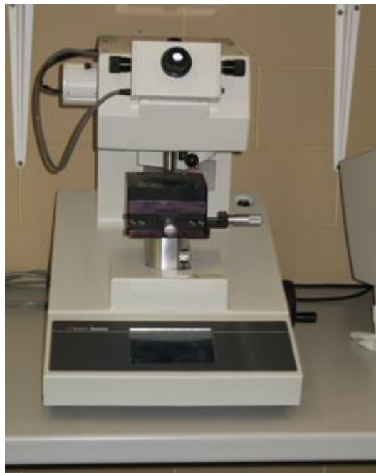
Figura 3.4 – Durómetro utilizado na medição de microdureza.
