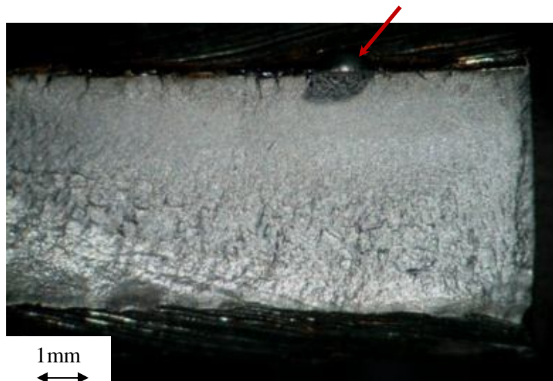
Figura 5.6 – Superfície de fractura, sendo visível a iniciação a partir de um pingo de soldadura.
