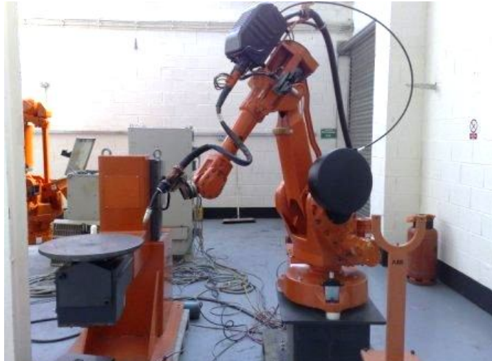
Figura 3.1 - Equipamento robotizado para soldadura MIG/MAG.
