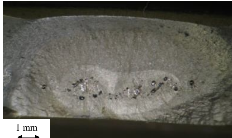
Figura 5.7 – Zona de iniciação de fadiga a partir de defeitos internos de soldadura.
