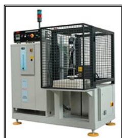
Figura 3.3 - Máquina de pré-aquecimento por indução HEAT 24
