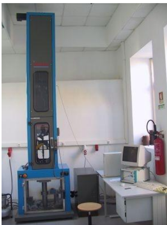
Figura 12. Máquina de ensaio ao impacto IMATEK-IM10.
