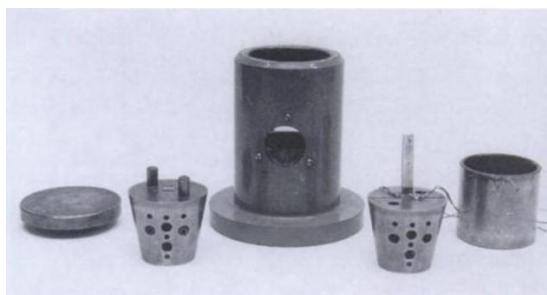
Figura 19. Sistema de fixação Celanese (Moura, 1995).
