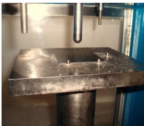
Figura 14. Dispositivo de suporte das placas simplesmente apoiadas.
