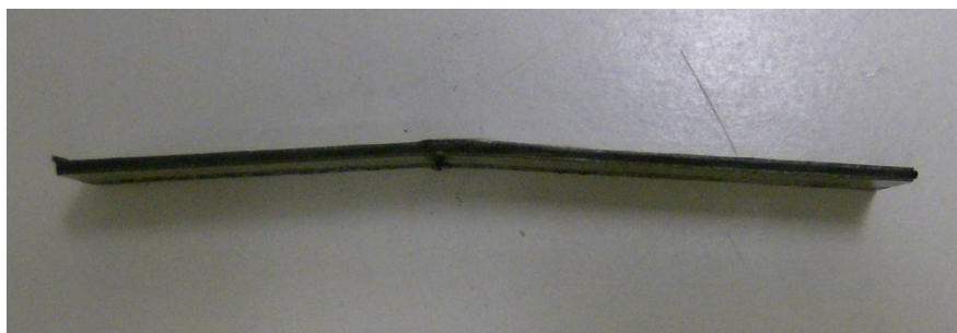
Figura 27. Vista transversal do provete 16SD1_S após ser submetido ao ensaio de compressão.
