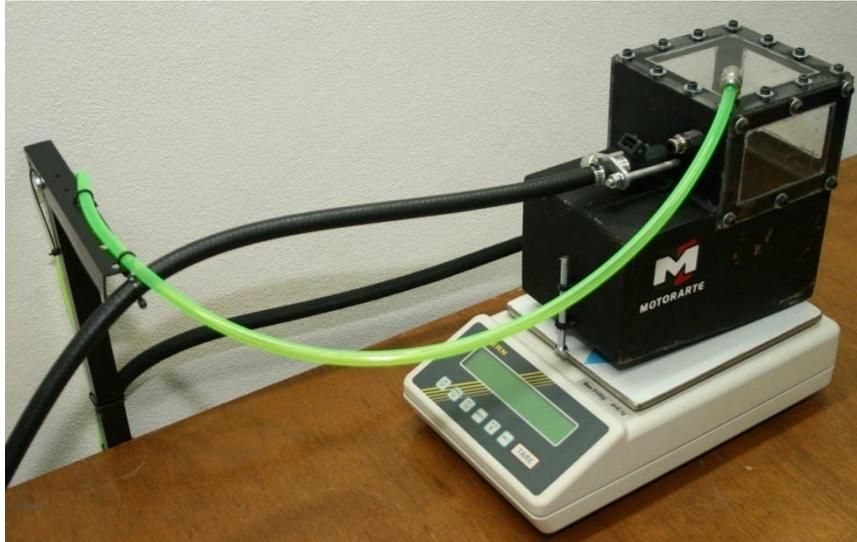
Figura 16: depósito de injeção e balança.
