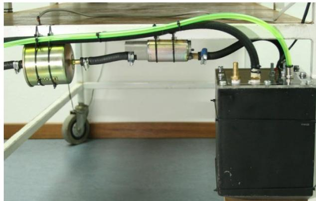
Figura 15: fotografia do depósito principal, sistema de elevação e filtragem.
