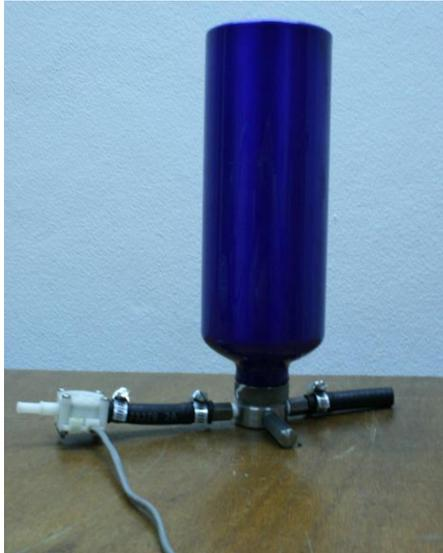
**Figura 18: fotografia do amortecedor de pressão e do sistema de medição I.**
