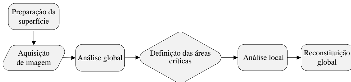
Figura 32. Fluxograma com as etapas principais do 'MCrack'.
