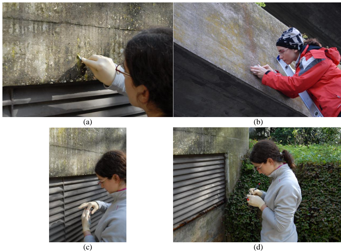
Figura 106. Procedimento de recolha de amostras de colonização biológica: (a) extracção com cotonete; (b) extracção com bisturi; (c) selagem; (d) catalogação.
