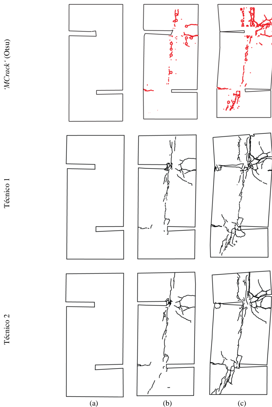
Figura 58. Mapas de fissuras definidos pelo ‘ MCrack ’ e pelo esboço de dois técnicos distintos: (a) fase inicial, fase #0; (b) fase intermédia, fase #3; (c) fase de rotura, fase #5.
