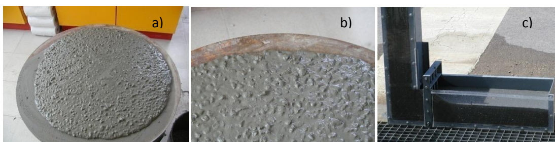
Figura 74 - Auto-compactibilidade do betão BACb+R ( a) - Ensaio de espalhamento; b) - pormenor do bordo do ensaio de espalhamento e c) - Ensaio na caixa L)
