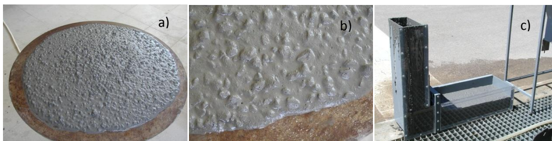
Figura 72 - Auto-compactibilidade do betão BACb-R ( a) - Ensaio de espalhamento; b) - pormenor do bordo do ensaio de espalhamento e c) - Ensaio na caixa L)
