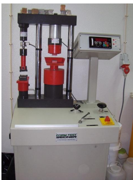
Figura 64 - Máquina de compressão e flexão de prismas
