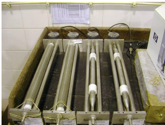
Figura 63 - Equipamento medidor de comprimentos desde o estado fresco, utilizado no presente trabalho
