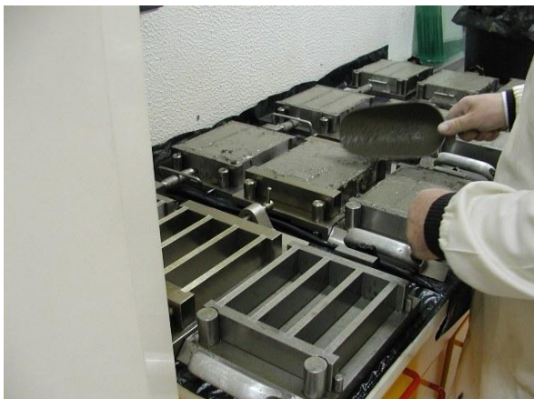
Figura 55 - Moldes utilizados na preparação de provetes para medição da resistência e respectivo enchimento.
