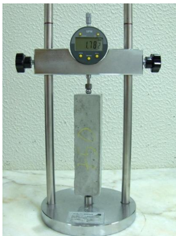
Figura 62 - Equipamento medidor de comprimentos, utilizado no presente trabalho.
