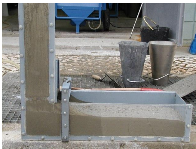
Figura 51 - Caixa L (utilizada no presente trabalho)
