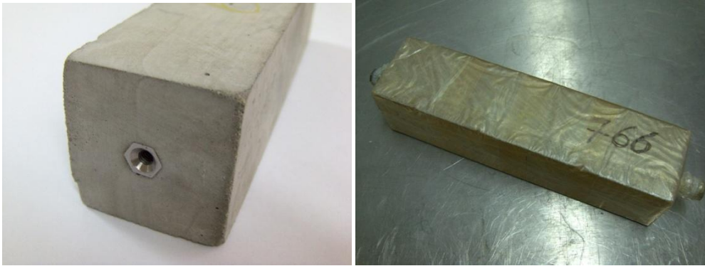
Figura 59 - Provetes para a medição da retracção: com secagem livre, à esquerda (não protegidos) e selados à direita.
