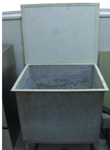
Figura 58 - Tanque para conservação dos provetes até à desmoldagem
