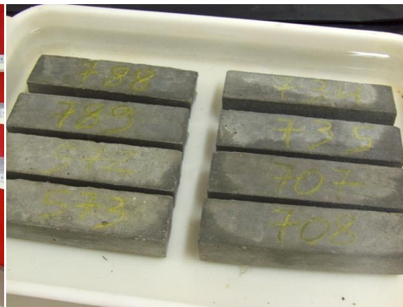
Figura 61 - Conservação de provetes imersos
