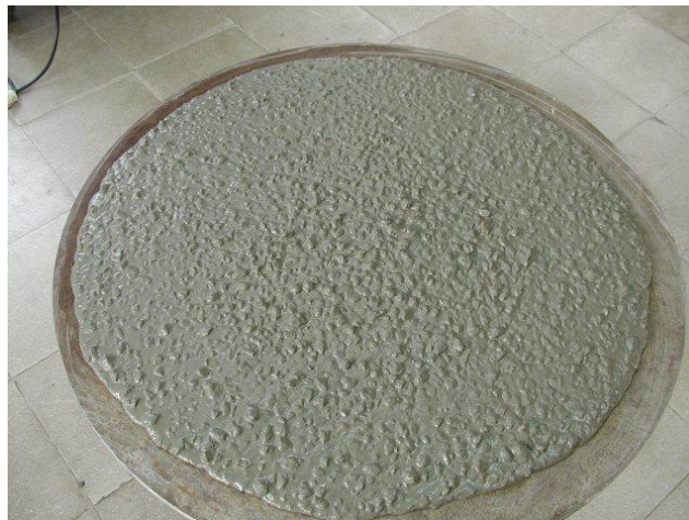
Figura 49 - Ensaio de espalhamento de betões
