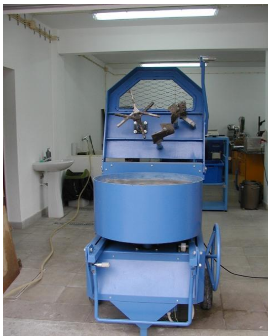
Figura 48 - Misturadora utilizada na produção dos betões
