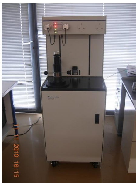
Figura 67 - Porosímetro de mercúrio
