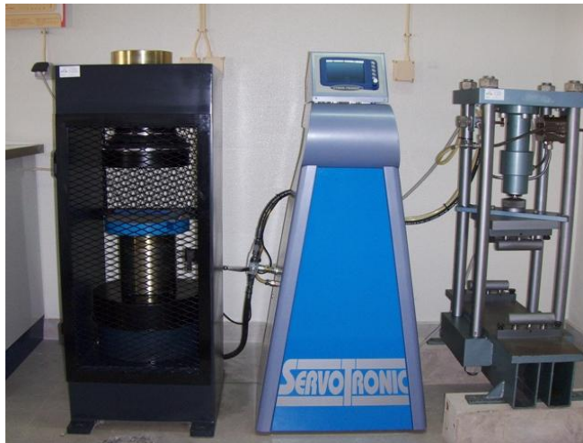
Figura 52 - Máquina de compressão
